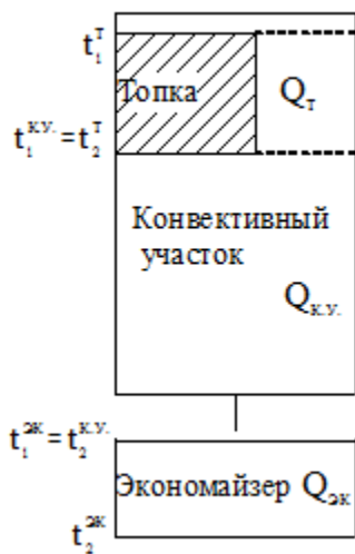
Рис. П.1.2. Тракты котлоагрегата
