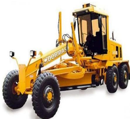
Рис. 1. Исследуемый автогрейдер ДЗ-122 Б
