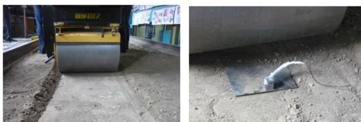
Рис. 1. Определение тенденции распространения виброволн на поверхности
