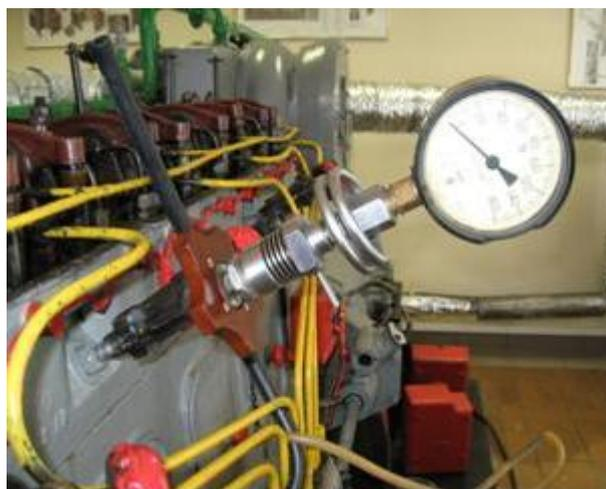
Рис. 2. Максиметр, дизель 6ЧН16/22,5
