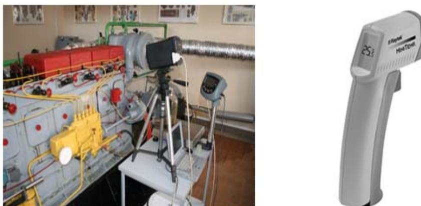
Рис. 1. Дизель 6ЧН16/22,5, тепловизор ИРТИС 2000 и пирометр Raytek MiniTemp
