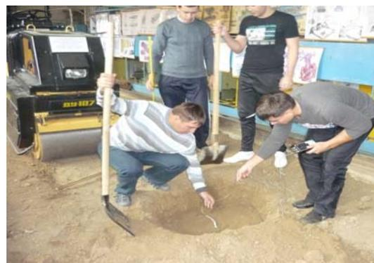
Рис. 3. Определение тенденции распространения виброволн в вертикальной плоскости грунтового слоя
