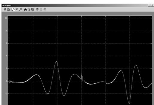
Рис. 11. Изменение напряжения в роторной цепи (в увеличенном масштабе)
