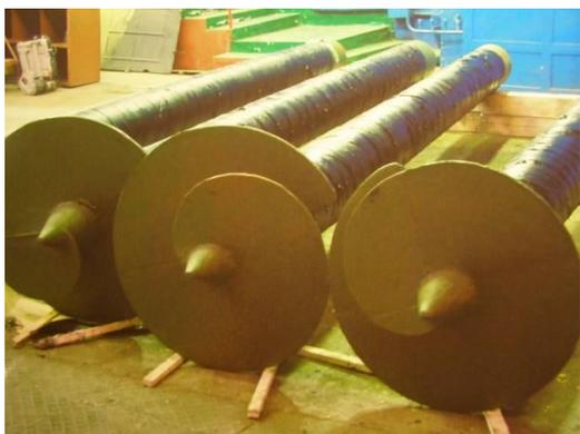
Рис. 2. Общий вид винтовых свай, использованных для сооружения фундаментов моста
