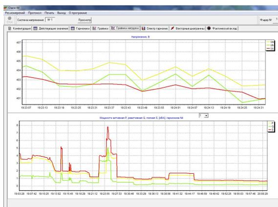
Рис. 12. Экспериментальные исследования отклонения напряжения
