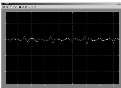
Рис. 10. Изменение напряжения в роторной цепи
