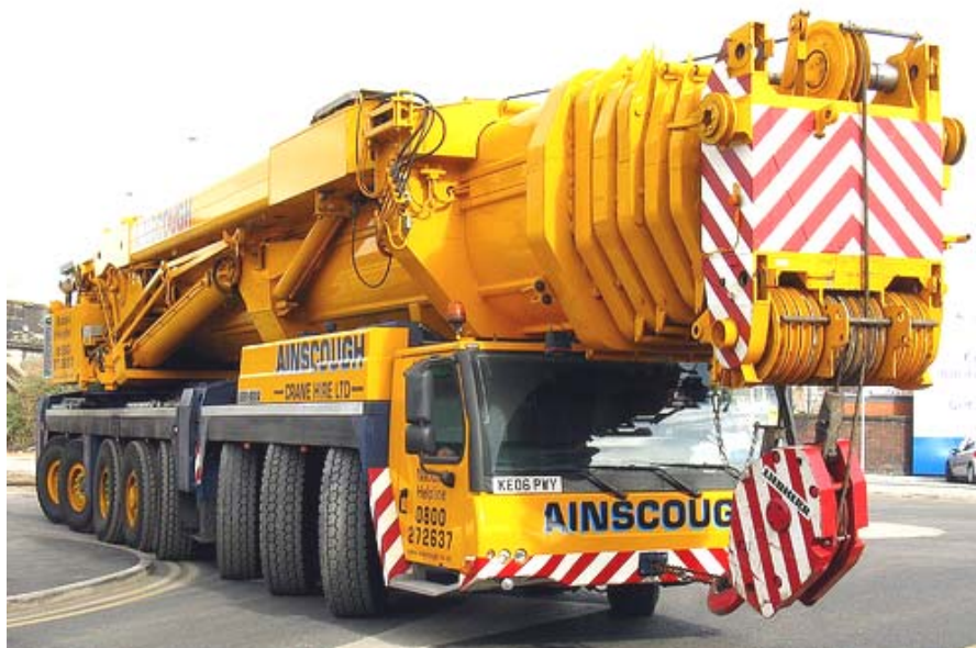
Рисунок 3.Автокран Liebherr LTM 1500-8.1 с управляемыми колесами шести осей
