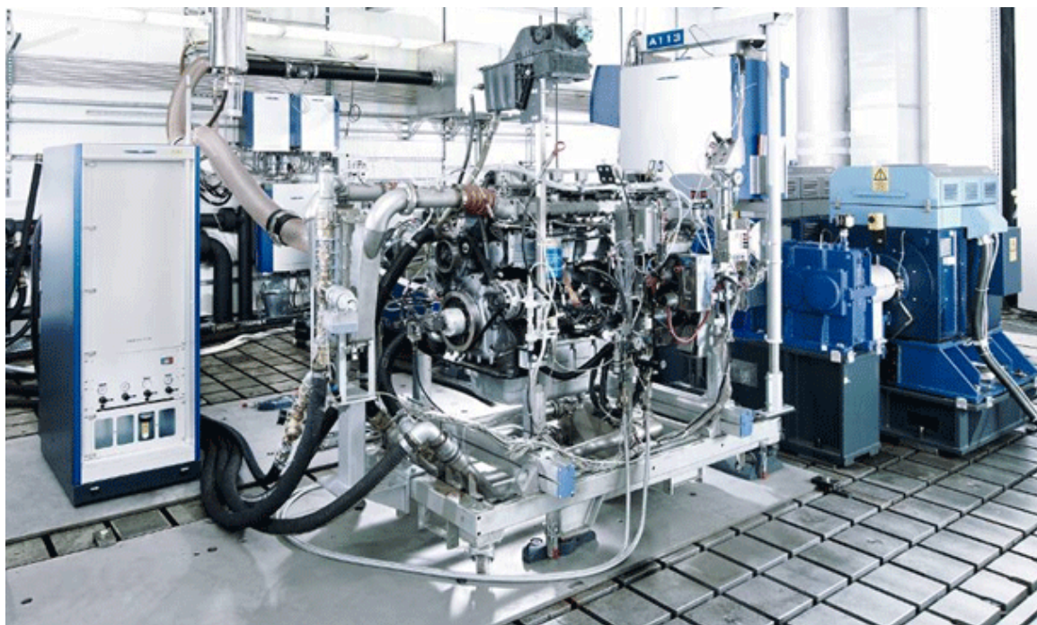
Рисунок 1. Стенд для испытаний двигателей фирмы AVL
