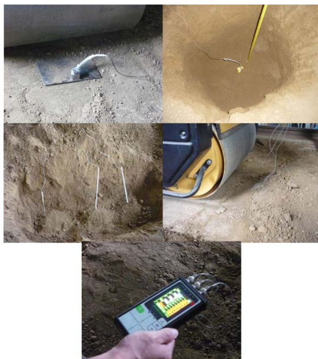
Рисунок 3. Фотографии экспериментальных исследований по определению эффективной толщины уплотняемого слоя
