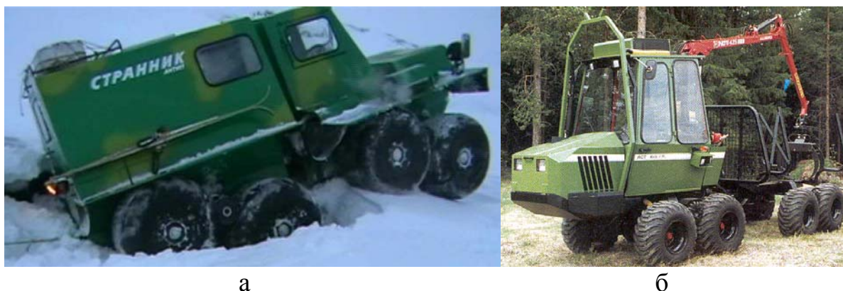
а – вездеход «Странник», б - мини-форвардер “AGT Rulle” Рисунок 1. ТС в конструкции которых используется роликовый привод колес
