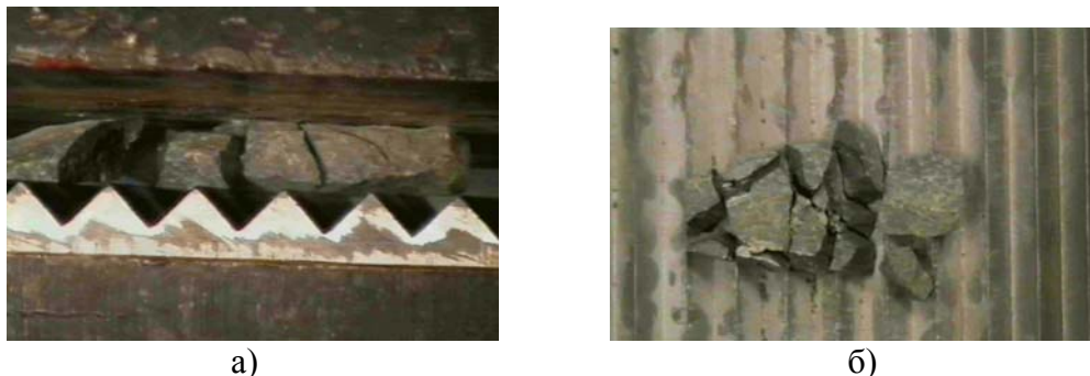
Рисунок 4. Разрушение лещадного материала дробящей плитой и плоскостью: а – разрушение лещадки; б – результат разрушения
