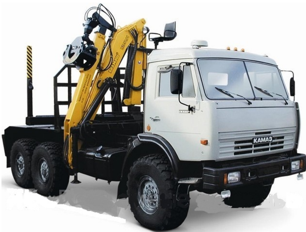
Рисунок 2. Манипулятор на базе автомобиля КамАЗ
