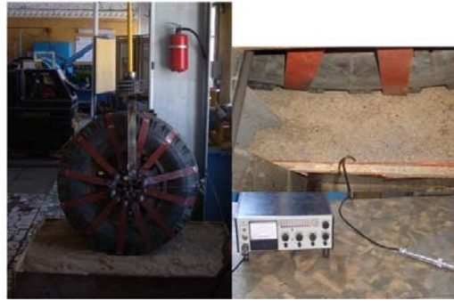
Рисунок 1. Регистрация виброускорения в грунте
