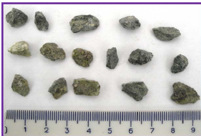
Рисунок 3. Гранулометрический состав выбуренного шлама при бурении скважины пневмоударником ПП110 ЭН
