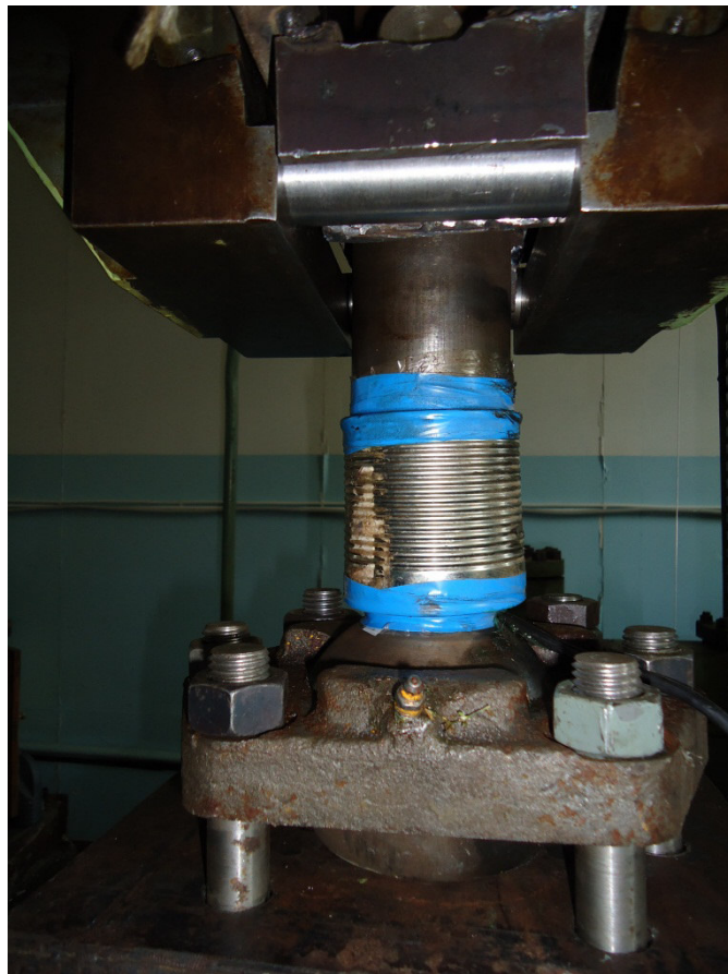
Рисунок 3.7 Тарировка датчика усилия с помощью разрывной машины ГРМ-1
