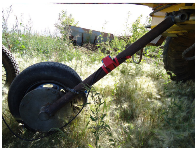
Рисунок 3.4 «Пятое колесо» для измерения действительной скорости
