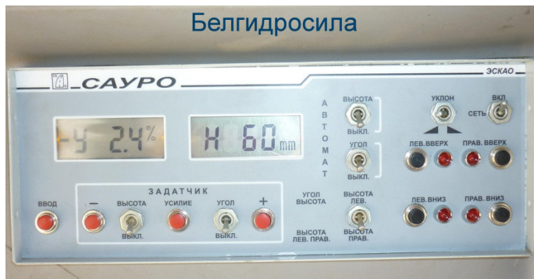
Рисунок 1.2 – Система нивелирования САУРО
