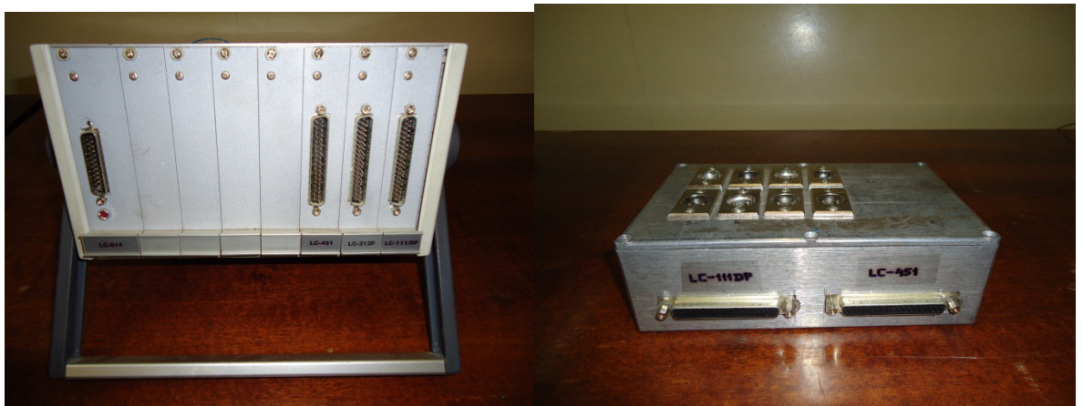
Рисунок 3.1 Лицевая панель крейта L-CARD
