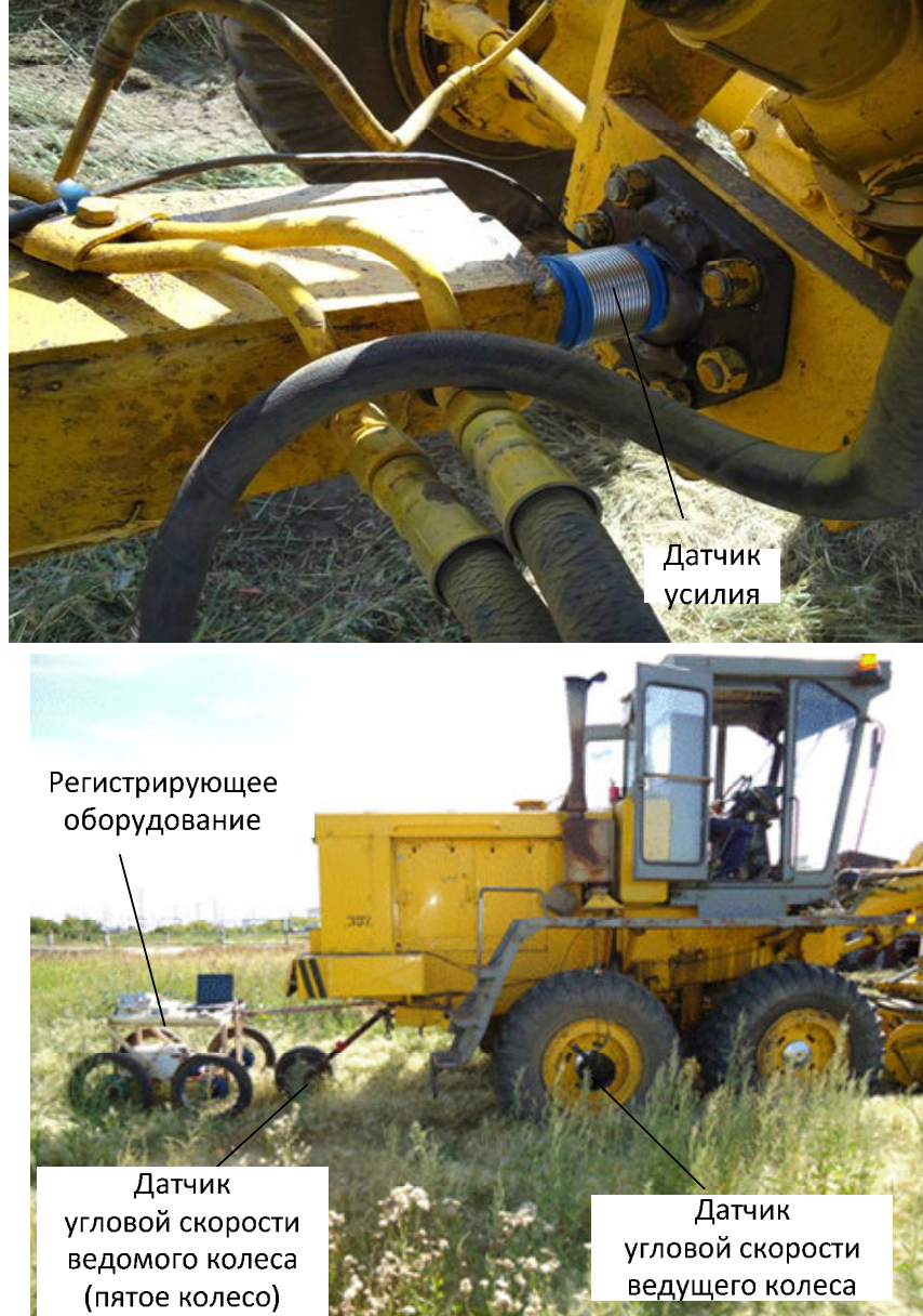
Рисунок 7 – Установка датчиков и БИК
