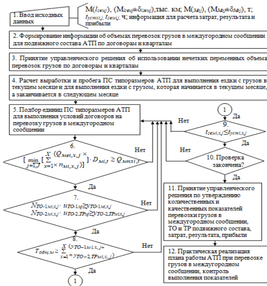
Рис. 9. Алгоритм методики текущего планирования работы специализированного ПС типоразмеров АТП для выполнения условий договоров при перевозке грузов в междугородном сообщении
