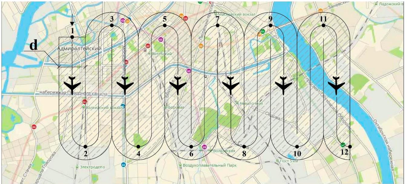
Рисунок 4 – Схема аэрографической съёмки
