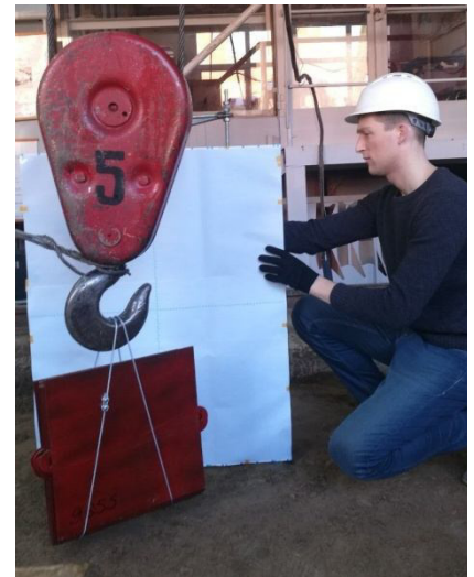
Рисунок 5.4 – Проведение экспериментальных исследований колебания груза
