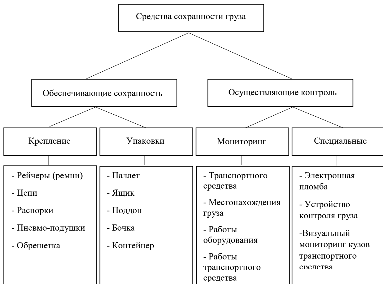
Рисунок 1.2. – Схема технических средств, обеспечивающих сохранность груза
