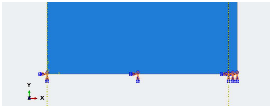
Рисунок 4.8.2.4 – Закрепление нижнего торца стойки
