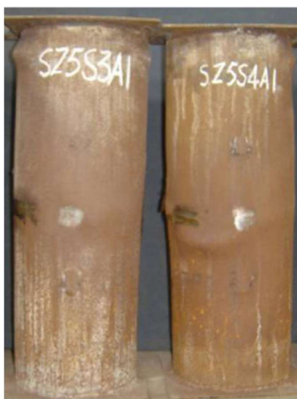
Рисунок 4.8.1.2.9 Трубобетонные образцы «типа 1» (слева) и «типа 2» (справа) после нагружения [100]
