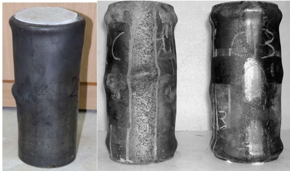
Рисунок 4.8.1.2.10 Местная потеря устойчивости стенки трубы трубобетонных стоек при испытаниях, проводимых:
