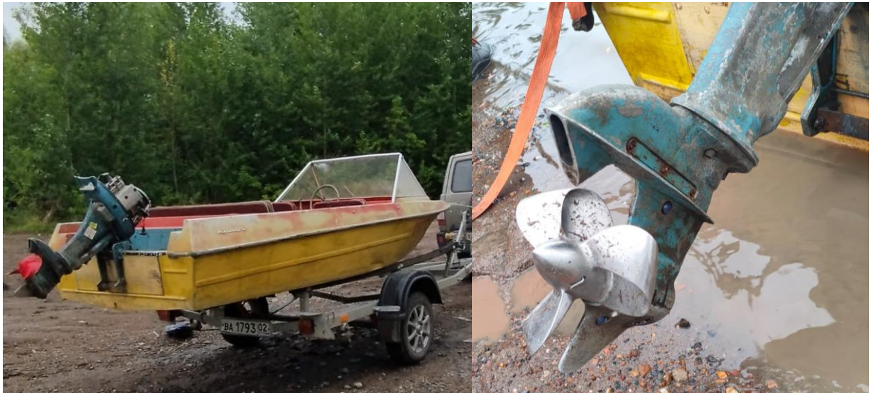
Рисунок 3.5 – Маломерное судно: а – со штатным гребным винтом; б – с опытным образцом
