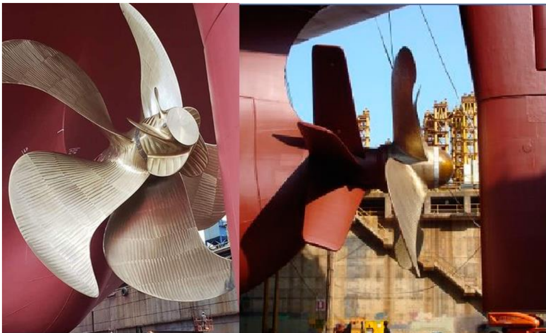
Рисунок 1.33 – Направляющие лопасти гребного винта: a – устанавливаемые после винта (Boss Cap Fins) б – устанавливаемые перед винтом (Pre-swirl Stator)
