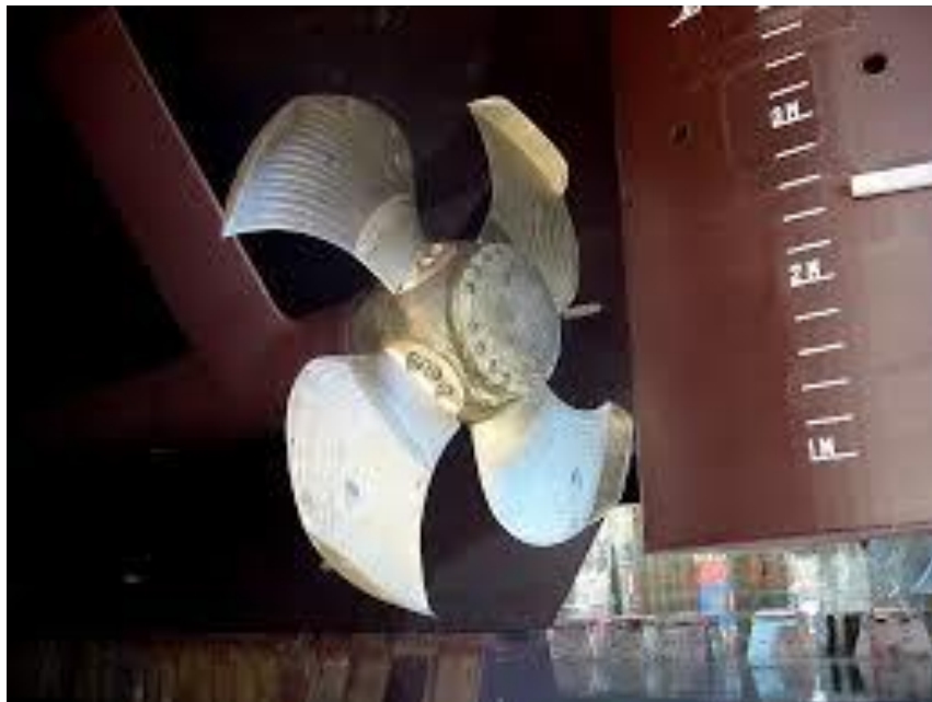
Рисунок 1.34 – ГВ с концевыми пластинами (Contracted Loaded Tip Propeller)
