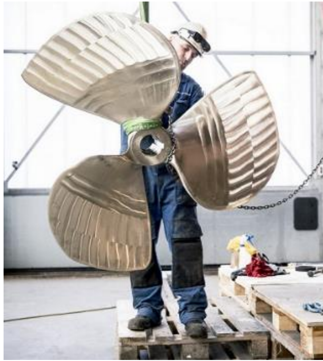
Рисунок 1.9 – Гребной винт WAAMpeller
