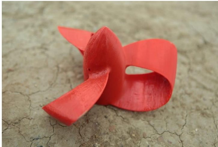
Рисунок 3.3 – Макет петлевидного винта
