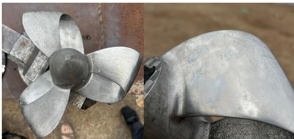
Рисунок 3.4 – 3D-печать из металла: а – опытный образец; б – финишная обработка
