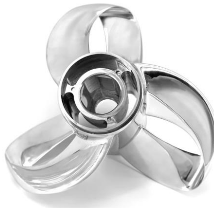
Рисунок 1.35 – Лопастной винт Sharrow propeller
