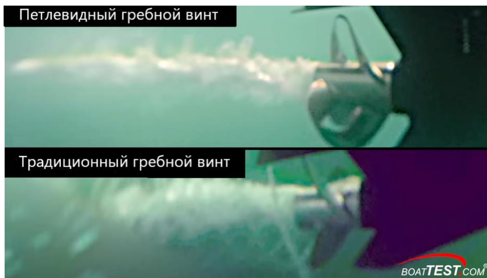
Рисунок 1. Вихревые течения при работе ЛВ
