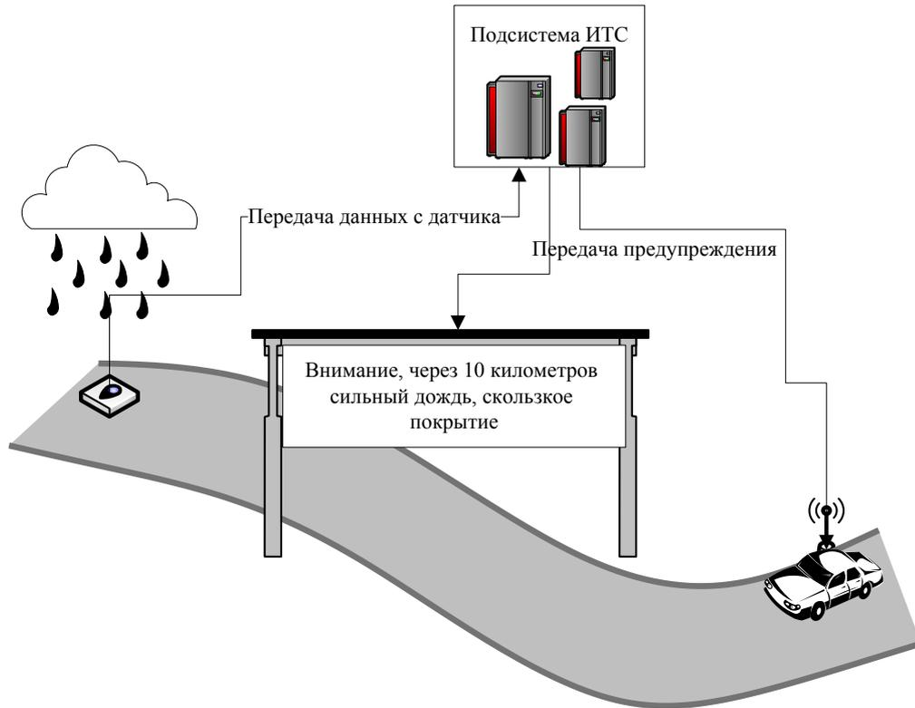
Рисунок 4.12 – Схема одного из перспективных вариантов передачи информации
