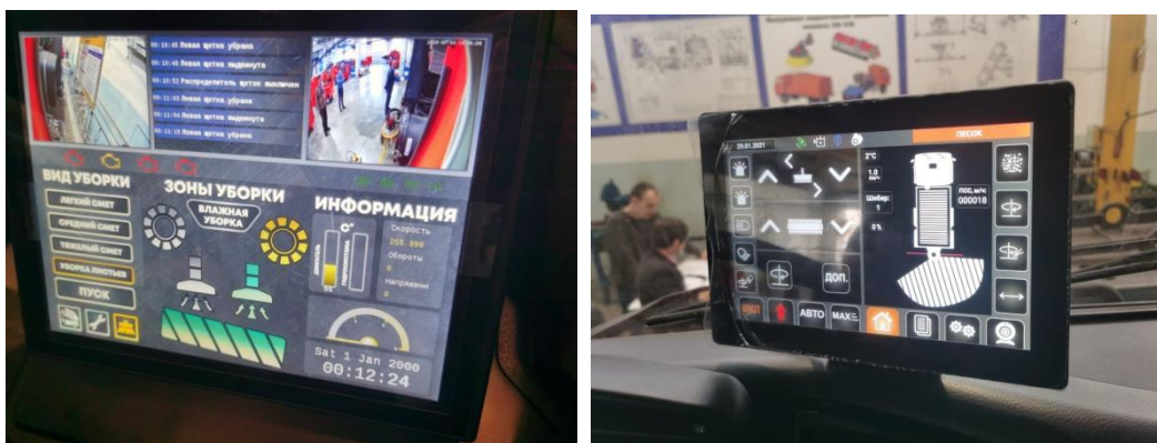
Рисунок 17 – Пример интерфейса бортового компьютера машин Курганского завода дорожных машин
