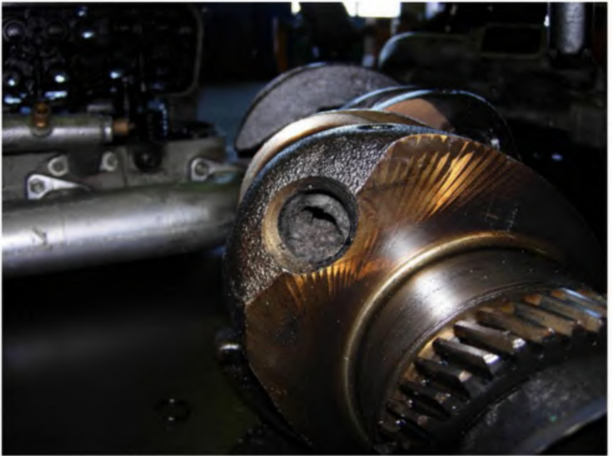
Рисунок 1.4– Отложения в ловушке коленчатого вала двигателя
