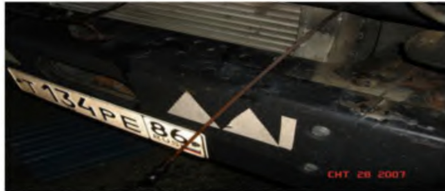
Рис. 4.18. Следы ржавчины на мерном щупе
