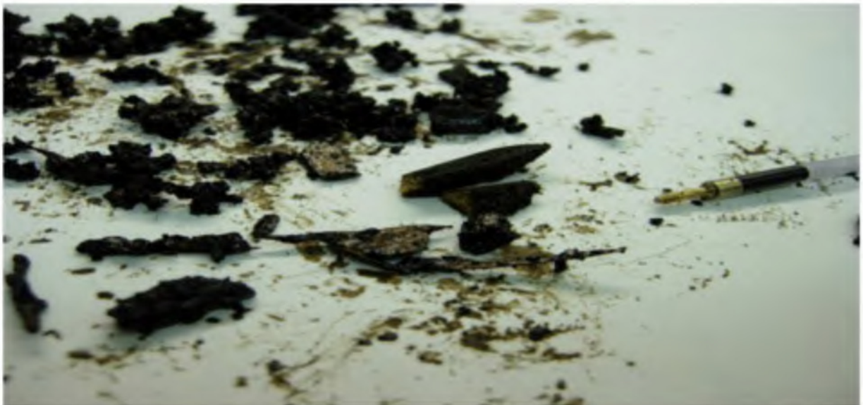
Рисунок 1.11 – Отложения из поддона картера двигателя
