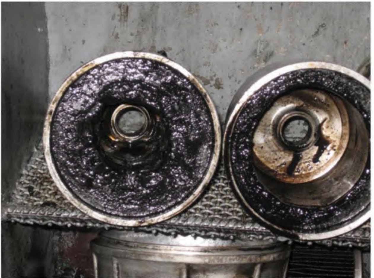
Рисунок 1.6– Отложения на стенках ротора фильтра центробежной очистки масла
