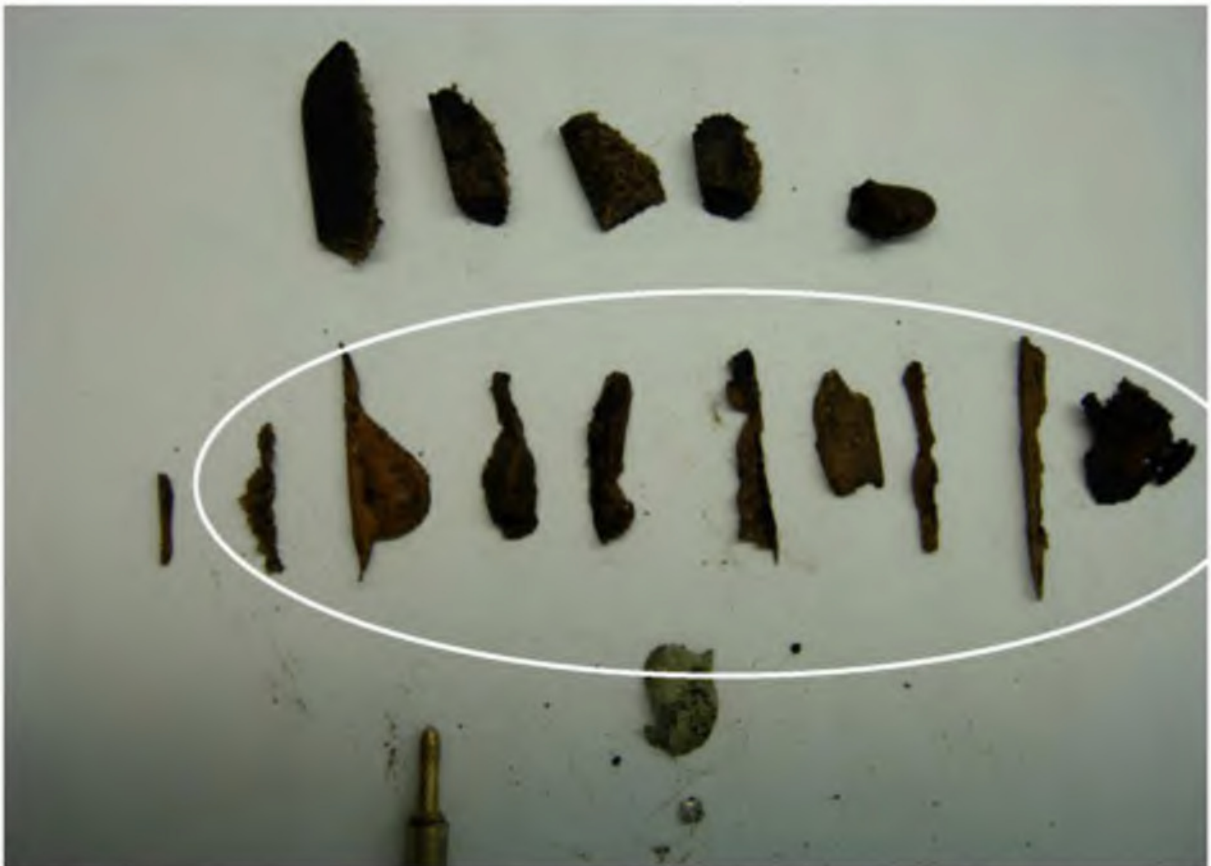
Рисунок 1.13 – Инеродные загрязнения (фрагменты герметика в системе смазки)
