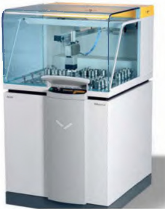
Рисунок 4.40 – Внешний вид спектрометра AxiosPV 4400 и его основные технические характеристики
