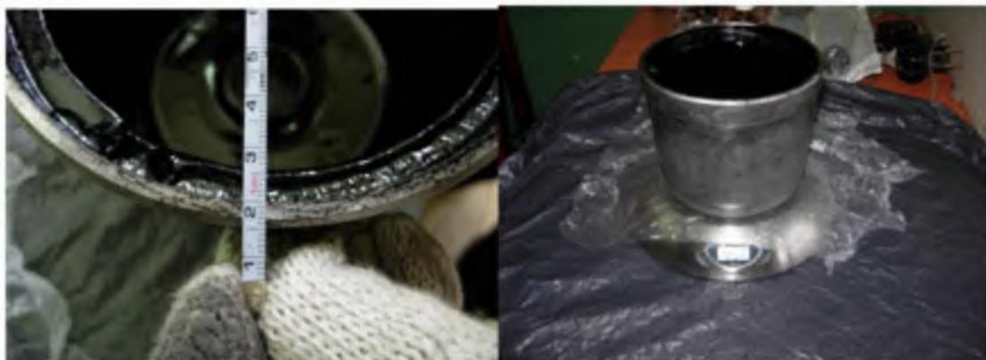
Рисунок 4.22 – Определение толщины отложений и взвешивание ротора центрифуги
