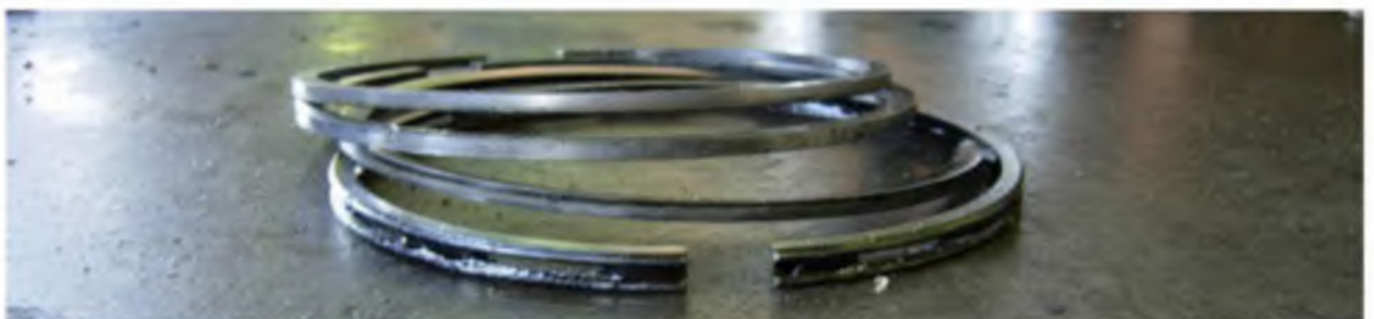
Рисунок 1.5– Отложения на поверхностях деталей ЦПГ
