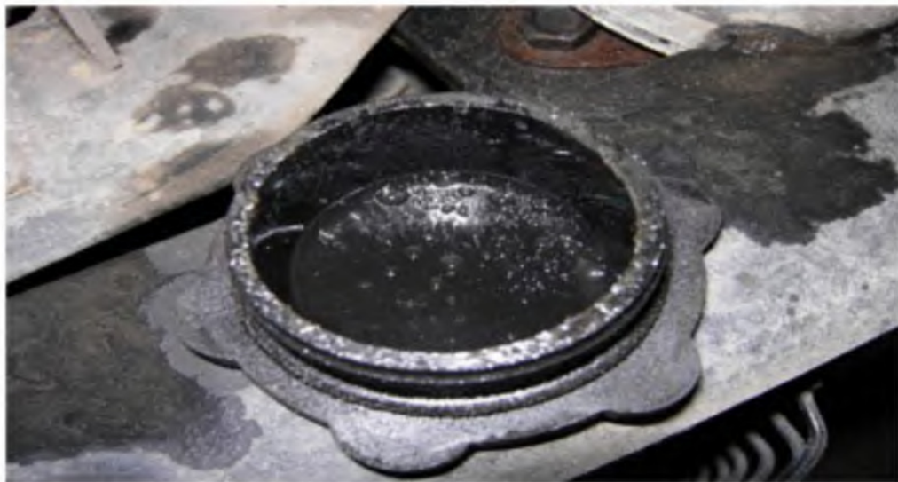
Рисунок 4.19 – Конденсат на крышке маслозаливной горловины
