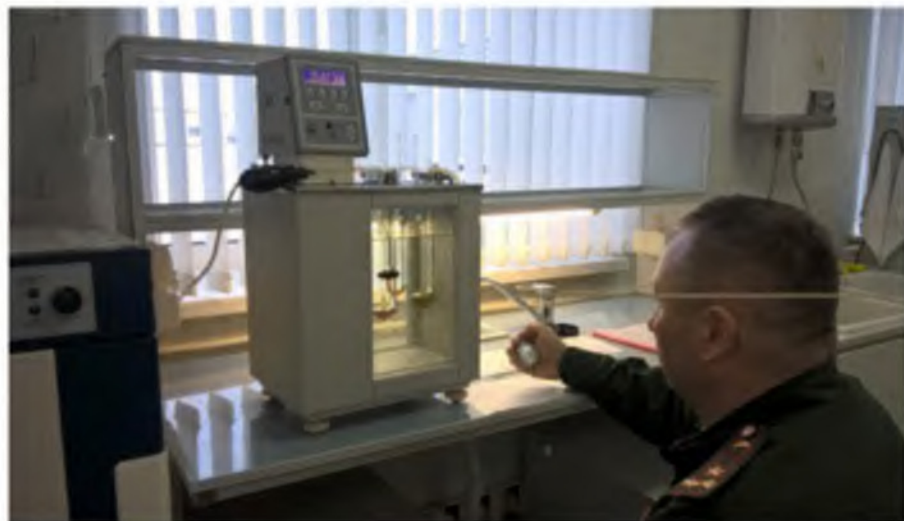
Рисунок 4.34 – Замер кинематической вязкости по ГОСТ 33-2000
