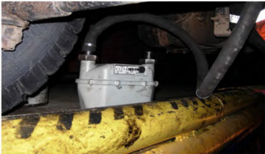
Рисунок 4.8 – Процедура замера расхода картерных газов и прибор СГМН-1
