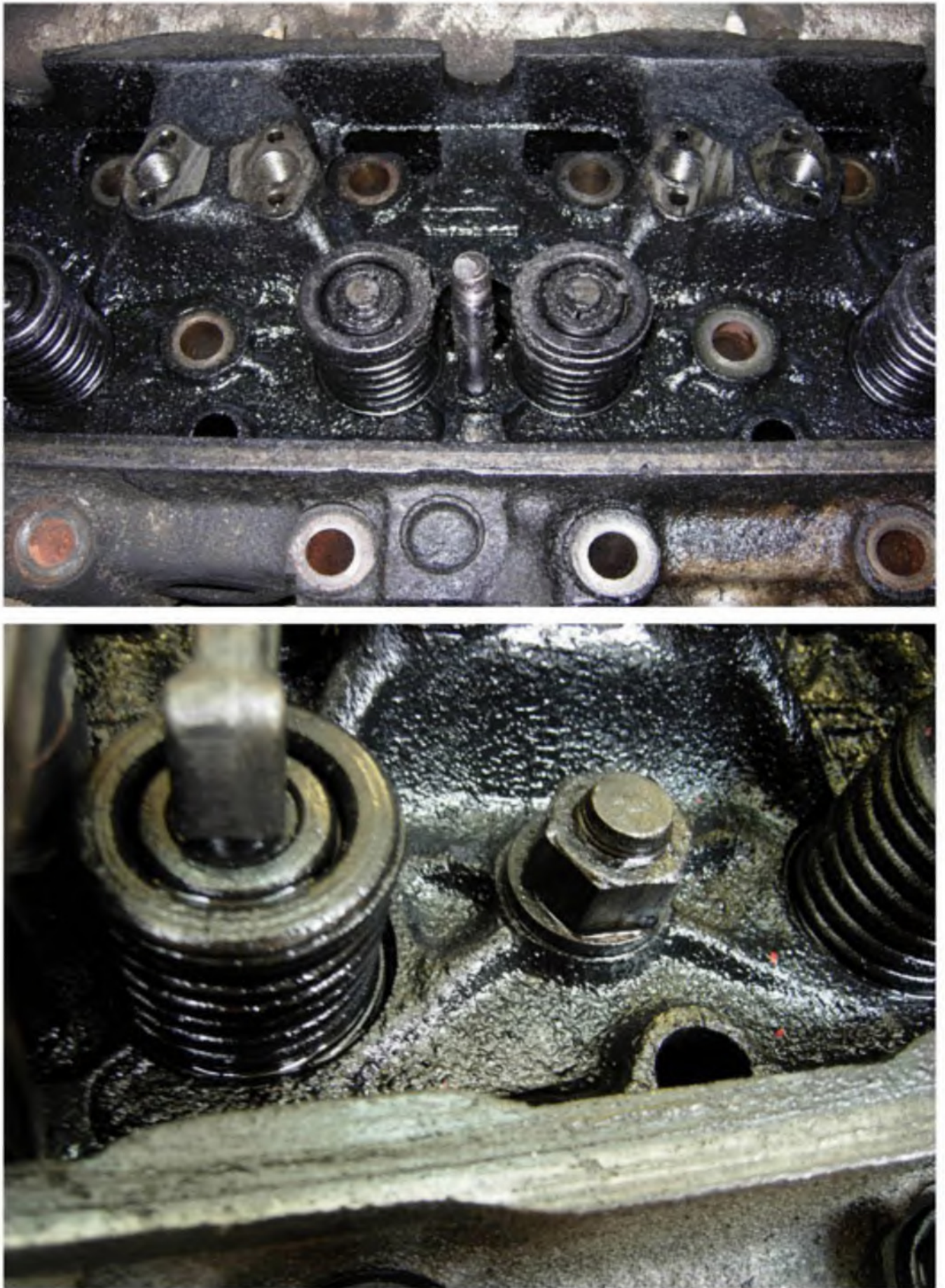
Рисунок 1.3 – Отложения на поверхностях головок блока цилиндров и деталях ГРМ
