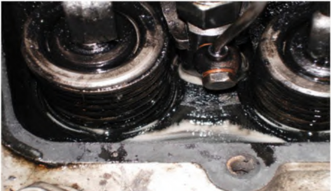
Рисунок 4.4 – Проверка герметичности обратной топливной магистрали
