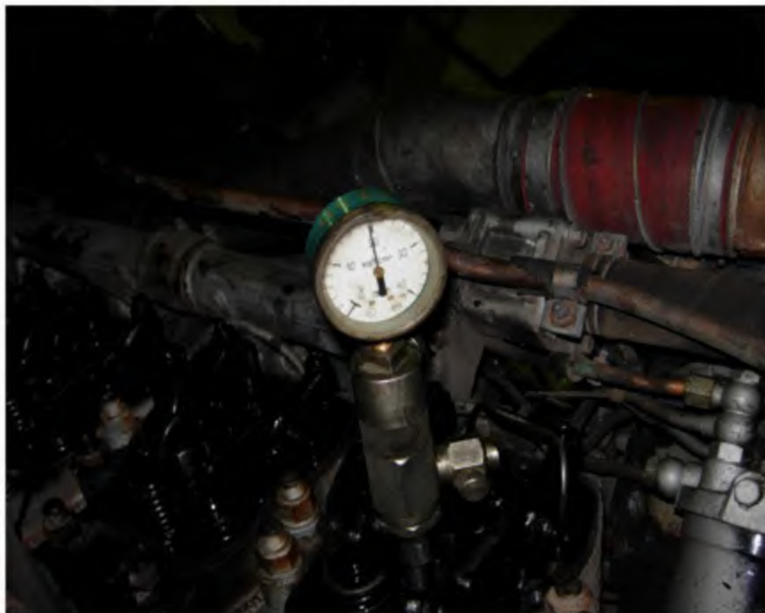
Рисунок 4.5 – Замер давления газа в конце такта сжатия.
