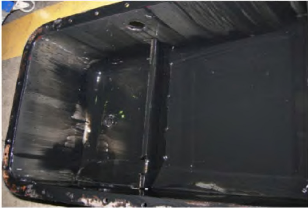
Рисунок 4.15 – Поддон картера, после промывки двигателя
