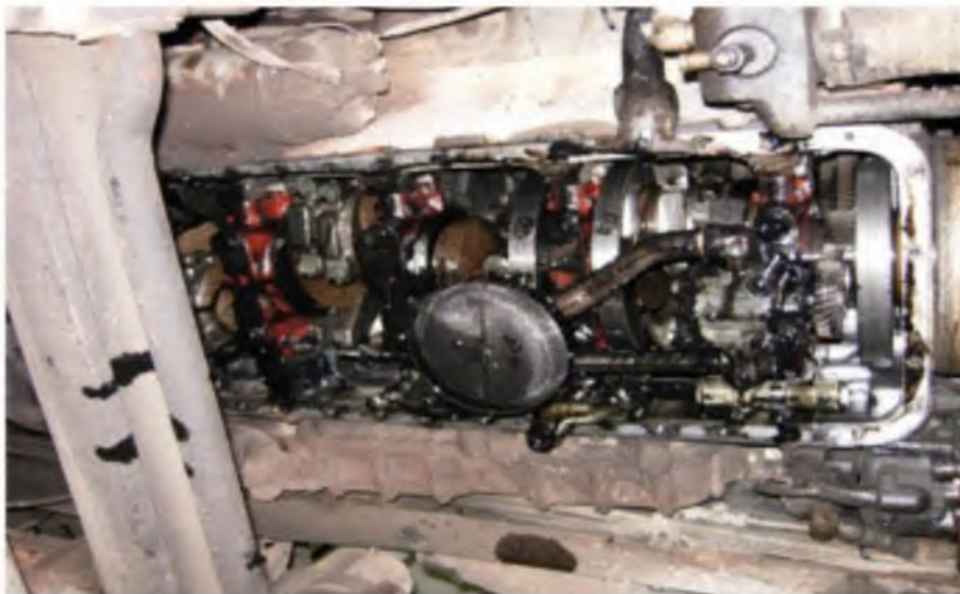
Рисунок 4.14 – Вид двигателя со снятым поддоном картера, после промывки
