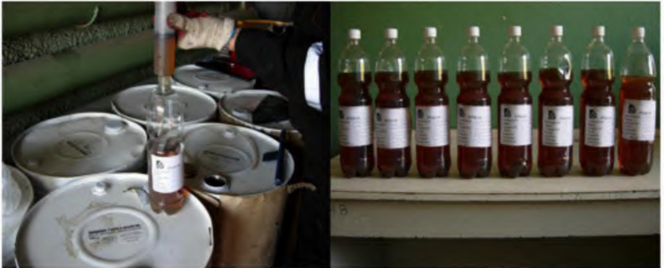
Рисунок 4.17 – Отбор проб свежего масла
