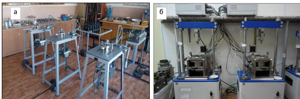
Рисунок 3.5 – Оборудование для исследований: а – приборы ПСГ-3М; б – приборы комплекса АСИС
