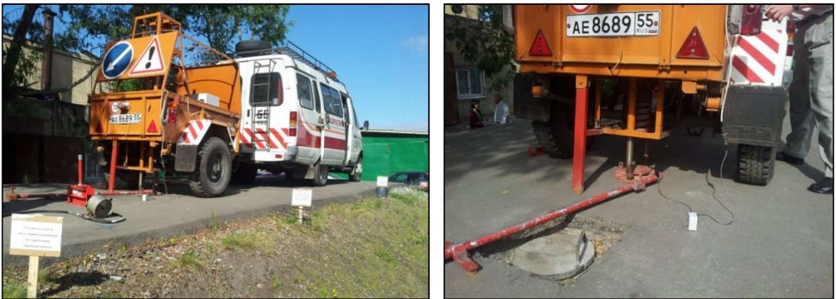
Рисунок 4.13 – Определение модуля упругости на поверхности покрытия при помощи УДН ДИНА-3М
