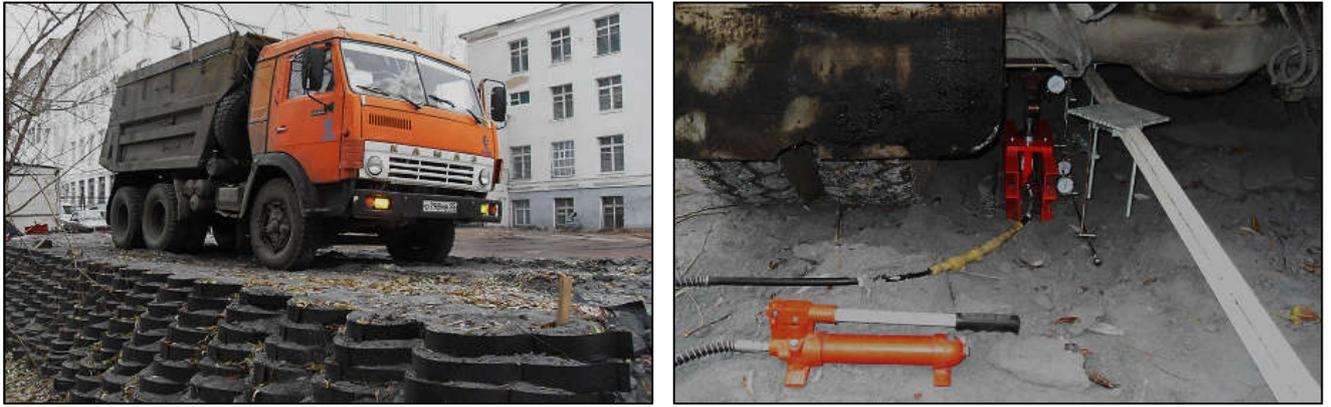
Рисунок 4.9 – Проведение штамповых испытаний
