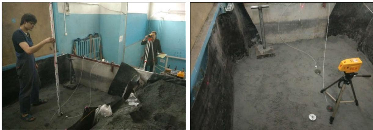
Рисунок 2.7 – Позиционирование датчика в массиве ЗШС
