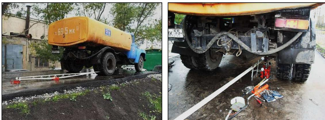
Рисунок 4.12 – Определение общего модуля упругости дорожной конструкции
