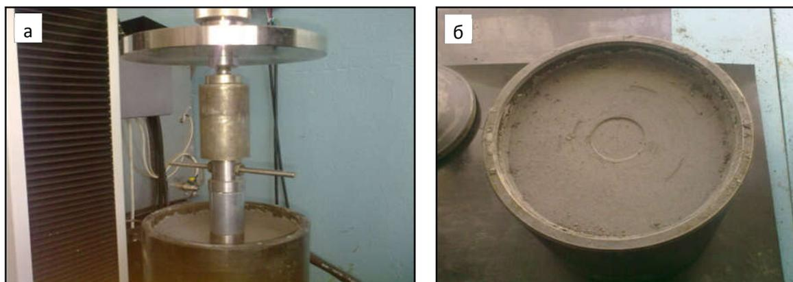
Рисунок 3.12 – Внешний вид испытательной формы, заполненной ЗПС
