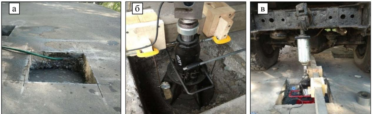
Рисунок 4.10 – Проведение штамповых испытаний: а – водонасыщение ЗПС; б – установка нагружающего устройства; в – измерение осадок штампа при нагружении
