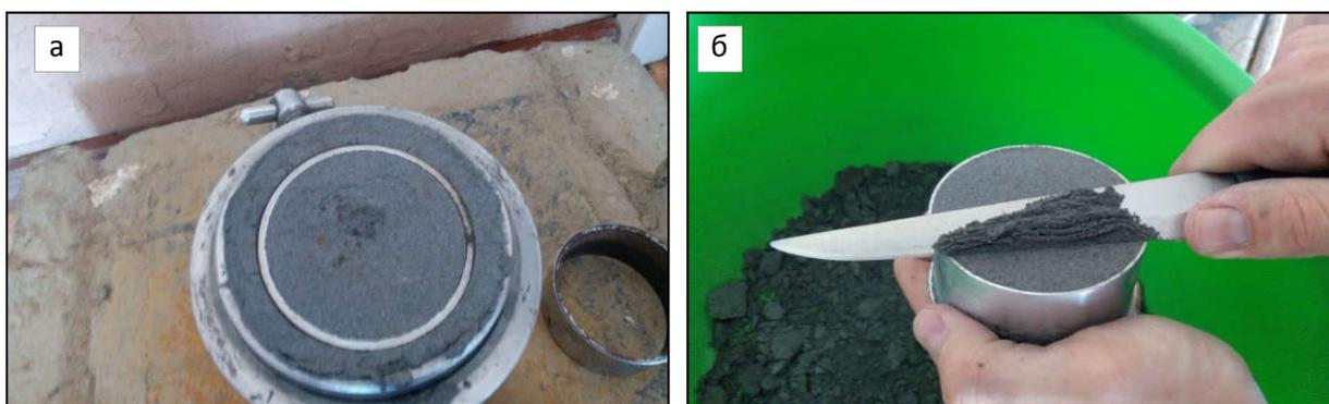
Рисунок 3.4 – Подготовка образца: а – кольцо врезано в образец в большом приборе стандартного уплотнения; б – формирование образца с требуемыми размерами
