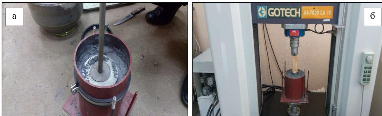
Рисунок 3.14 – Процесс испытания: а – процесс уплотнения ЗШС в форме; б – форма, установленная в машину для испытаний
