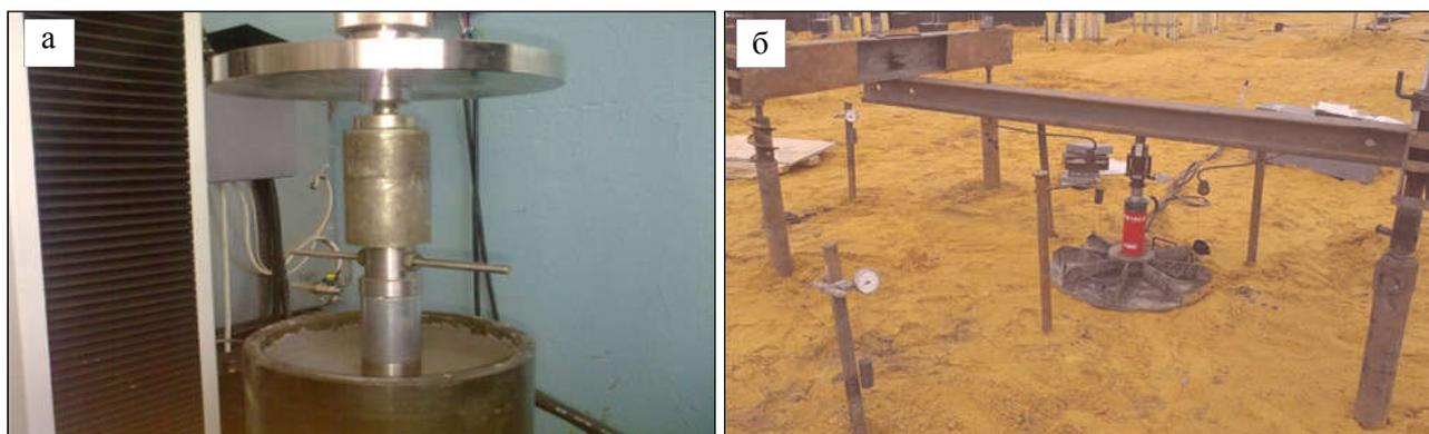
Рисунок 3.3 – Лабораторный и полевой метод определения модуля упругости: а – испытания по методике рычажного пресса; б – штамповые испытания
