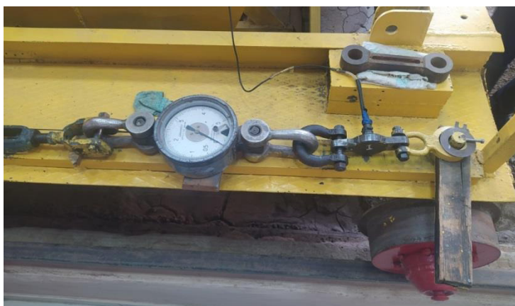
Рисунок 3.21 – Тарировка электронной тензотяги
