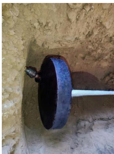
Рисунок 3.25 – Экспериментальная установка с фрезерной головкой
