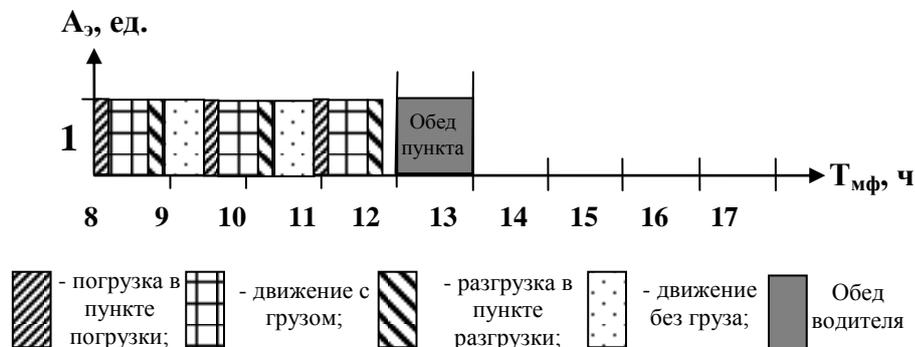
Рисунок 3.2 – График работы «почасового» АТС (пример 2.2)
