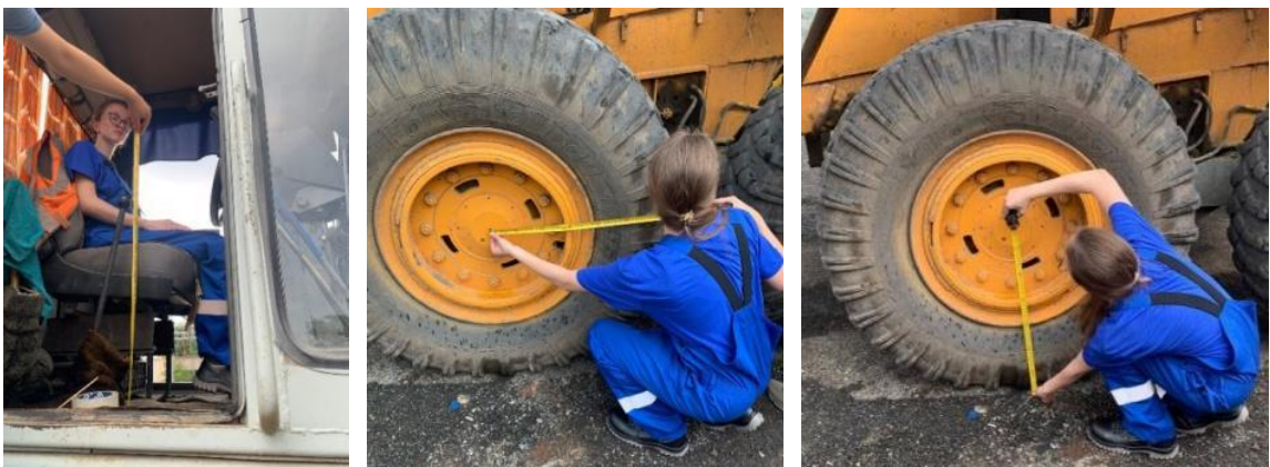
Рисунок 5.2 – Определение основных геометрических параметров автогрейдера
