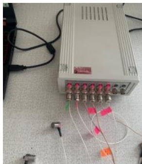
Рисунок 5.3 – Общий вид виброизмерительной аппаратуры ZETLAB 017-U8 с акселерометрами
