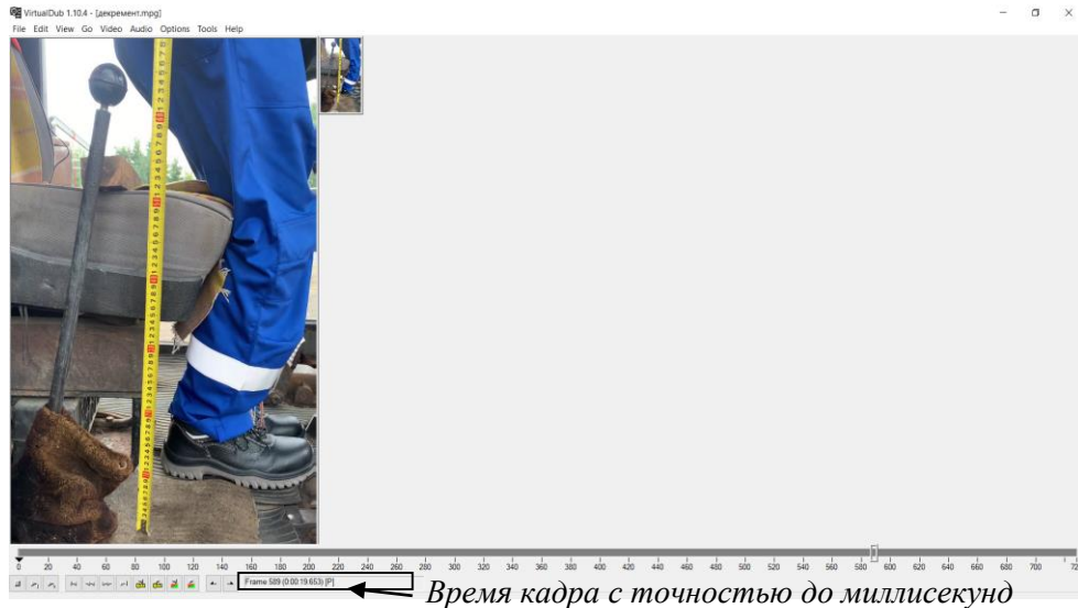
Рисунок 5.5 – Окно редактора видеофайлов Virtual Dub 1.10.4 с фрагментом кадра видеозаписи колебаний сиденья человека-оператора
