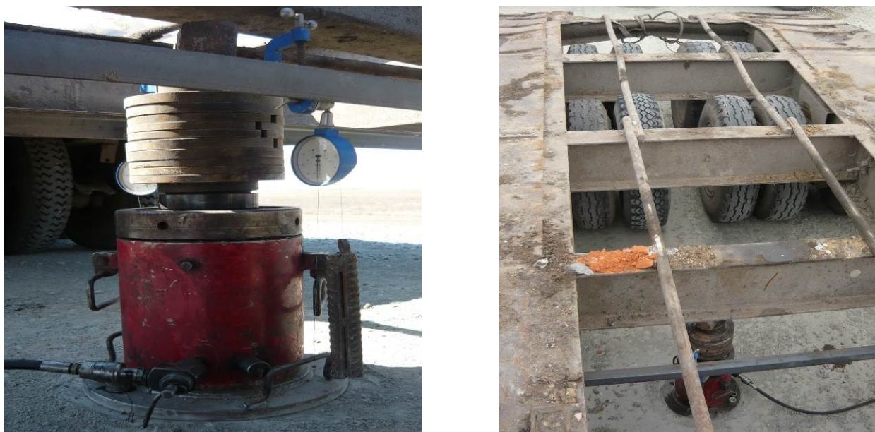
Рисунок 2.14 – Проведение штамповых испытаний
