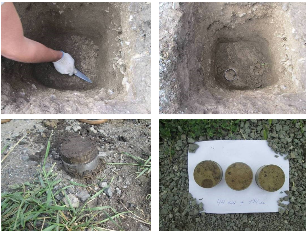
Рисунок 2.8 – Процесс отбора проб грунта методом режущего кольца
