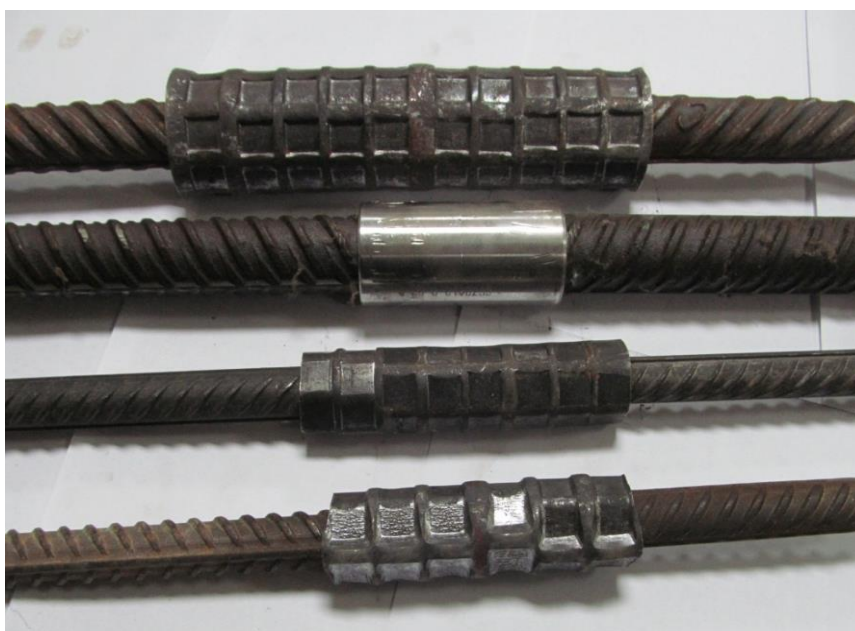
Рисунок 1.10 - Арматура различного диаметра, соединенная разными типами скрепления
