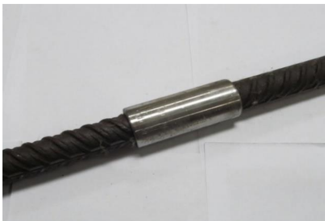
Рисунок 1.5 - Готовое соединение с помощью резьбовой муфты
