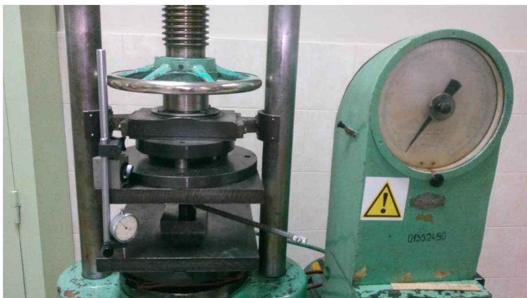
Рисунок 3.1 - Пресс ПСУ-50 с установленной заготовкой.
