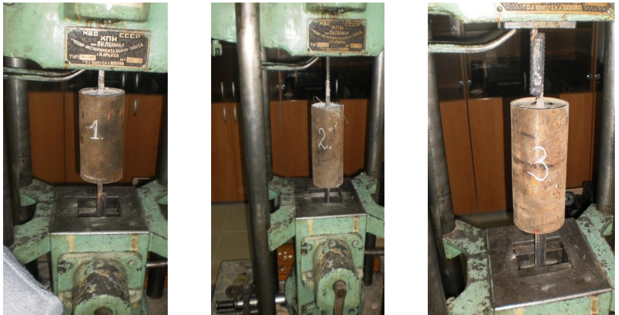
Рисунок 3.17 - Процесс испытания на разрыв в слое бетона
