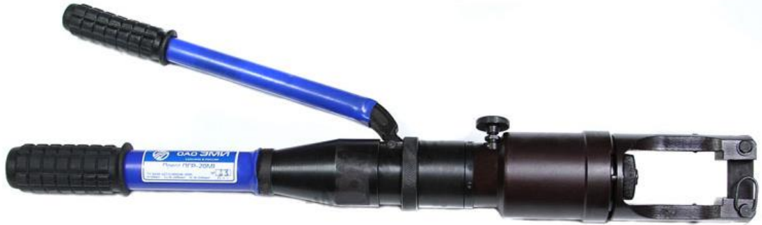
Рисунок 1.12 - Пресс ручной гидравлический ПГР-20М
