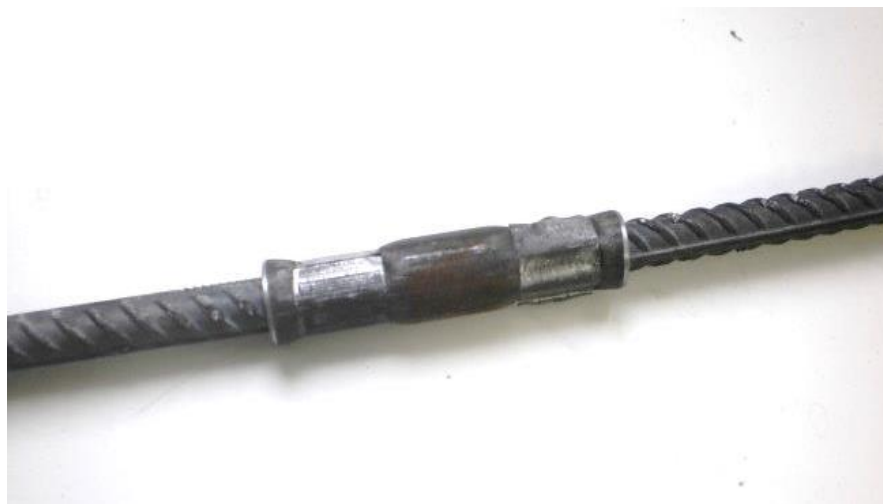
Рисунок 3.6 Готовое соединение двух стержней арматуры
