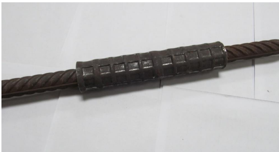
Рисунок 1.9 - Арматура, соединенная с помощью опрессовки в стальной втулке
