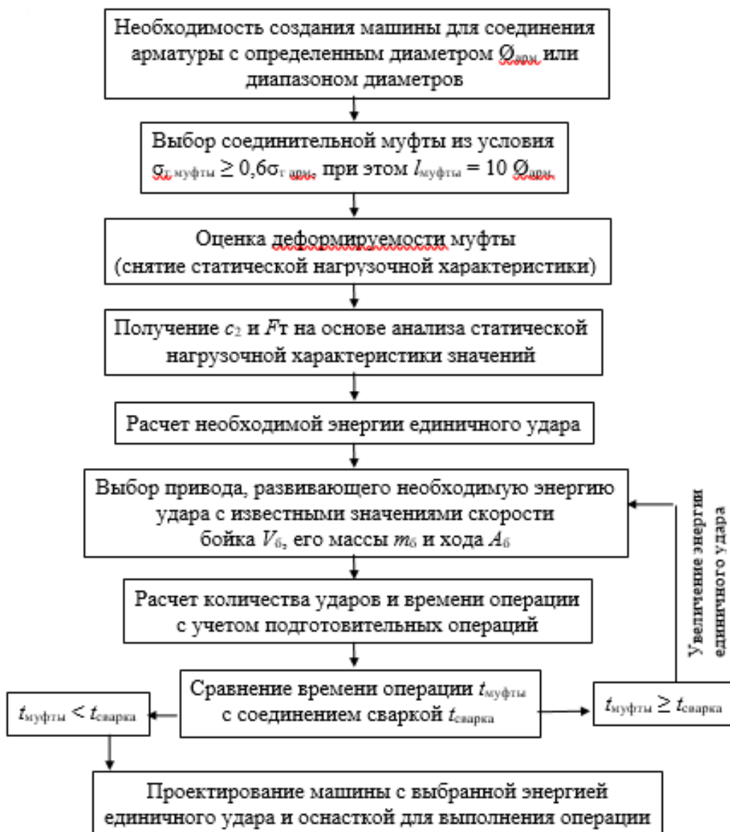
Рисунок 4.1 - Методика проектирования ручной ударной машины.
