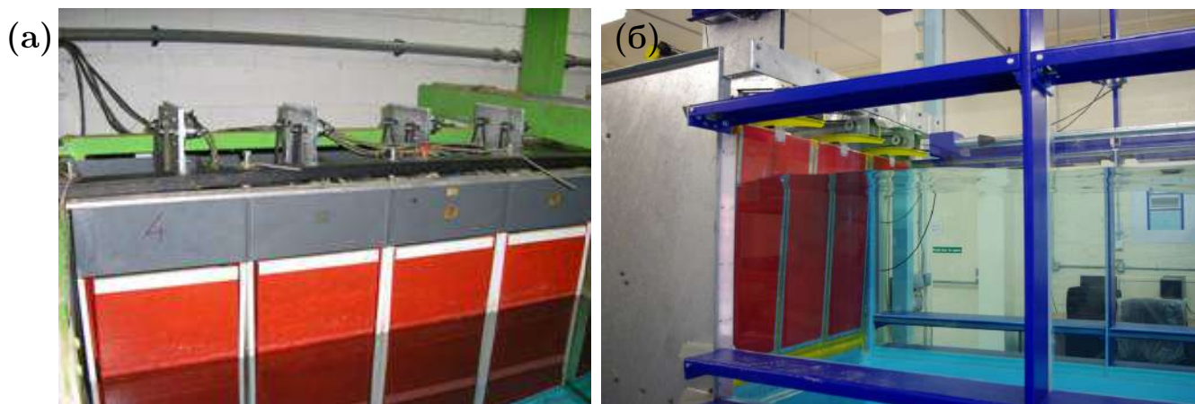
Рис. 7.1. Фотографии лабораторного шарнирно закрепленного волнопродуктора: (а) большой гидроволновой лоток Тель-Авивского университета (Израиль), в котором проводились экспериментальные исследования диссертантом; (б) волнопродуктор, изготовленный компанией Edinburgh Designs (Англия).
