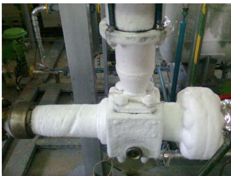
Рис. 5.34. Фотография образца разделительной вихревой трубы ВТ 30-50 с места ее эксплуатации.
