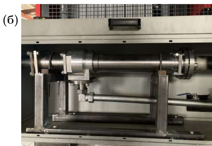
Рис. 5.32. Фотографии опытных образцов вихревых труб, сделанные на заводе-изготовителе: (а) ВТ 30Р и (б, в) РЕСШ.4414.
