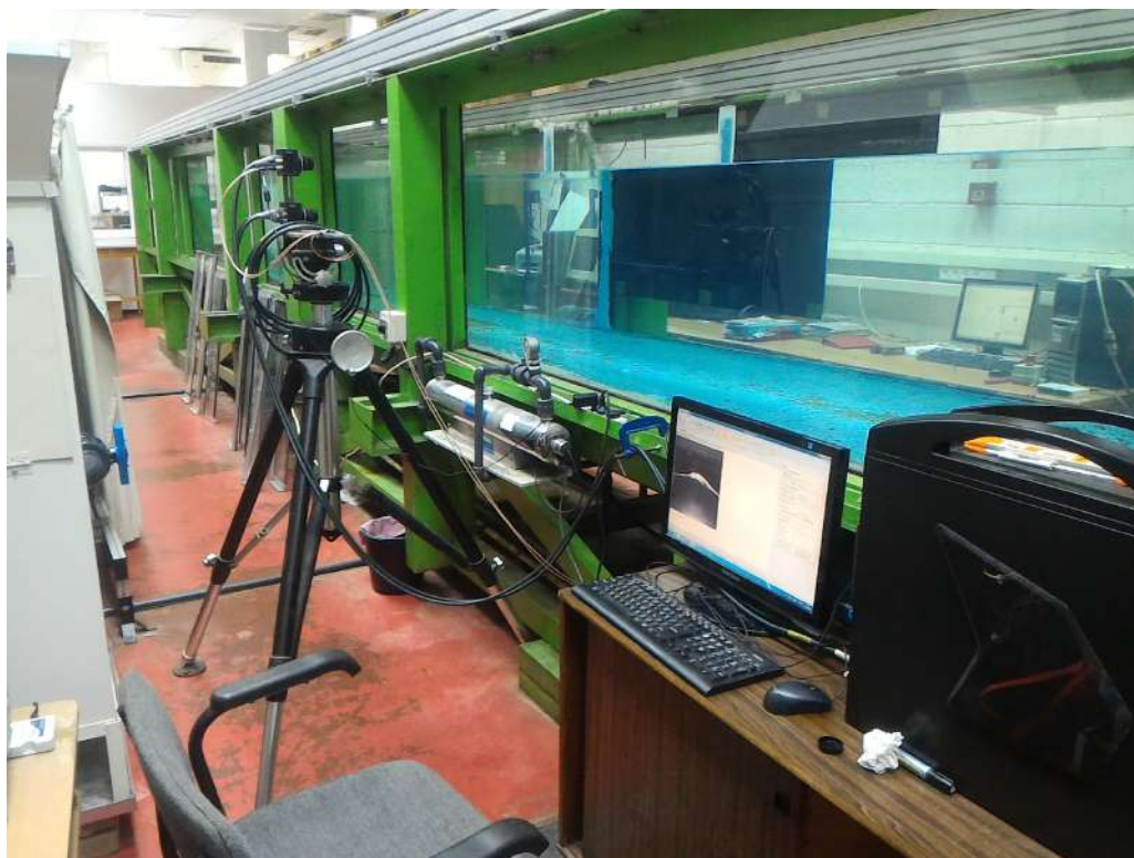
Рис. 6.2. Фотография лабораторной установки (гидроволнового лотка) в Тель-Авивском университете (Израиль). Фотография сделана во время проведения экспериментов лично соискателем.
