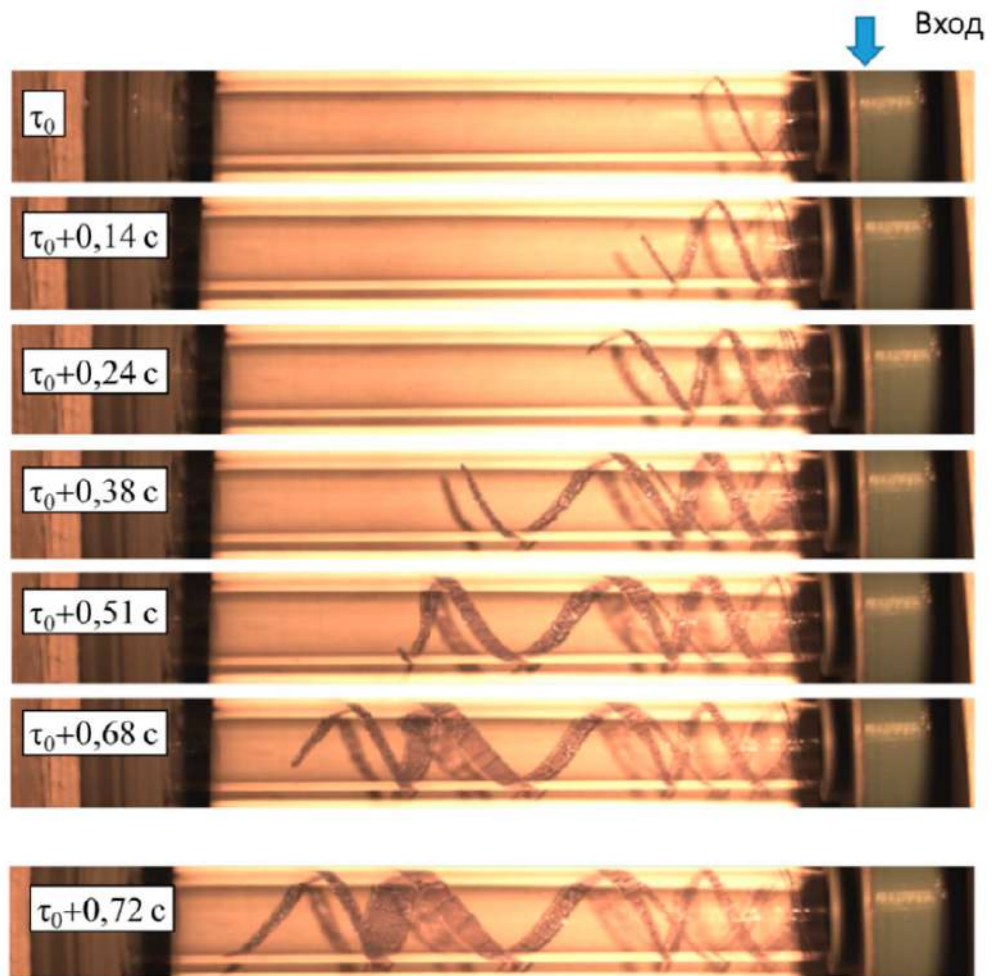
Рис. 2.6. Визуализация структуры течения воды в вихревой трубе путем подкрашивания жидкости через иглу в закручивающем устройстве [198]
