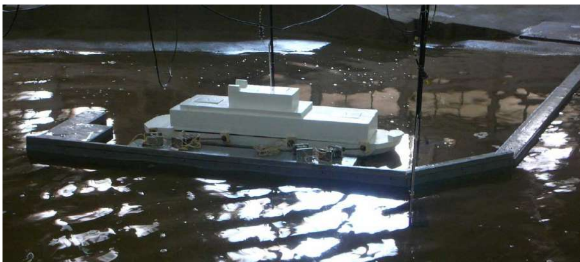
Рис. 3.4. Лабораторные исследования по воздействию волн цунами на модель плавучего энергоблока, выполненную в масштабе 1:100. Фотография заимствована из статьи [295].
