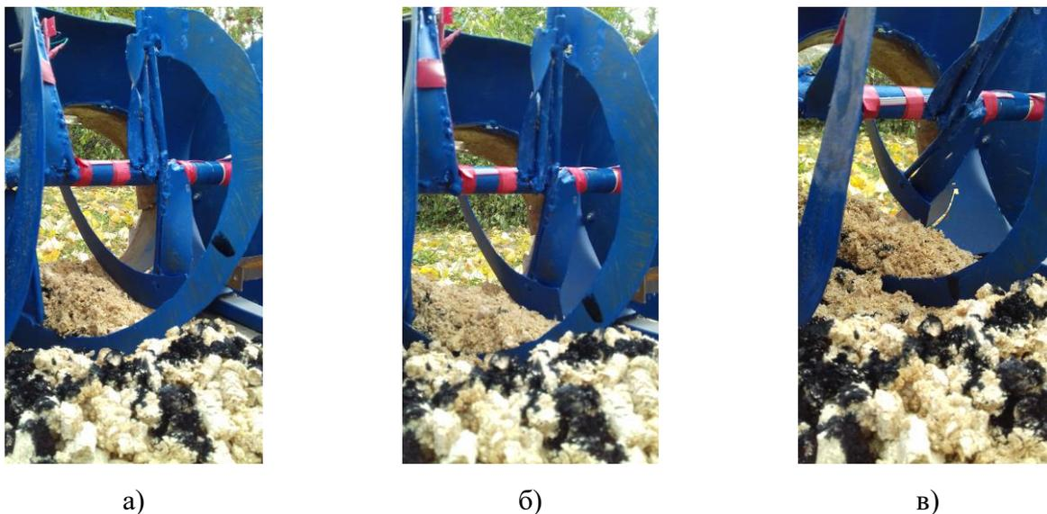
Рисунок 19 – Экспериментальное определение фактически не попавшей в область загрузочного окна снежной массы при различных углах поворота фрезы
