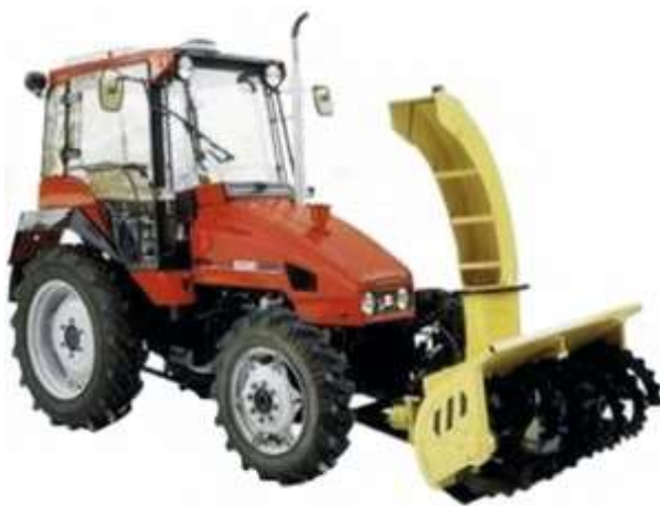
Рисунок 1.8 – Фрезерно-роторный снегоочиститель на базе трактора ВТЗ-2048А ФРС
