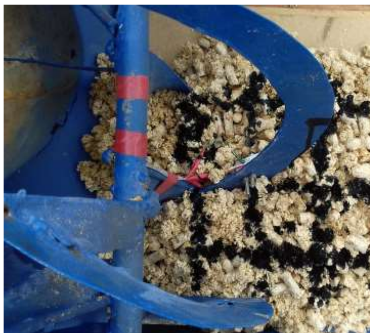
Рисунок 5.4 – Экспериментальная установка по определению фактически потерянной снежной массы при различных углах поворота фрезы (вид сверху)
