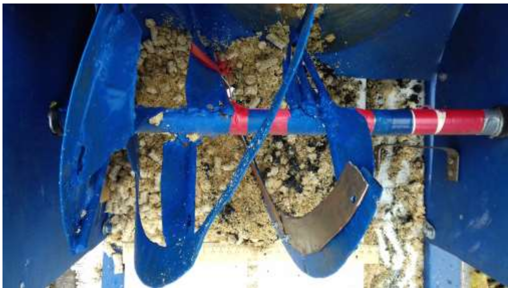
Рисунок 5.6 – Экспериментальная установка по определению фактически потерянной снежной массы в зависимости от угла поворота фрезы с переменной шириной (вид сверху)
