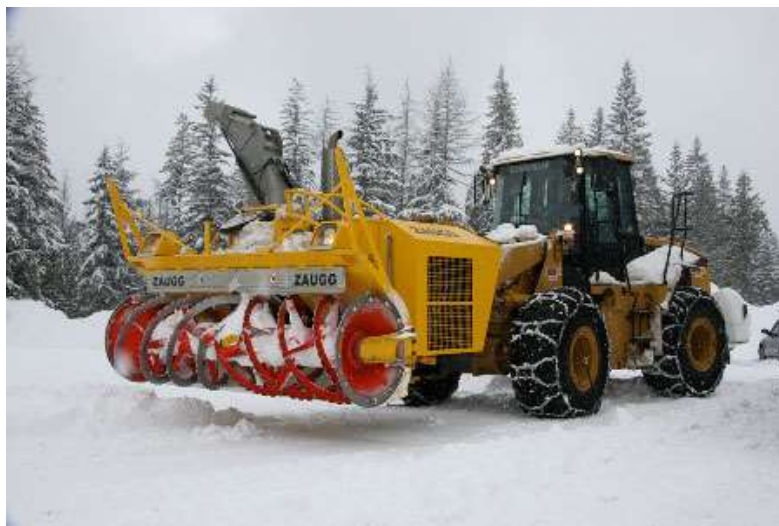
Рисунок 1.18 – Моноблок MB-320 ZAUGG с фрезерно-роторным рабочим органом ZAUGG SF-90
