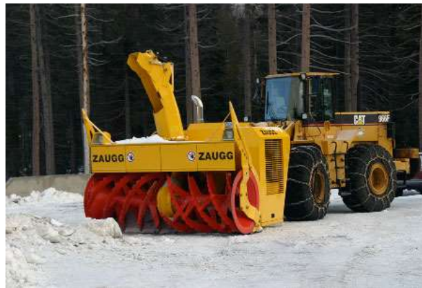
Рисунок 1.17 – Моноблок Mobi 570 ZAUGG с фрезерно-роторным рабочим органом ZAUGG SF-120-125-R-296
