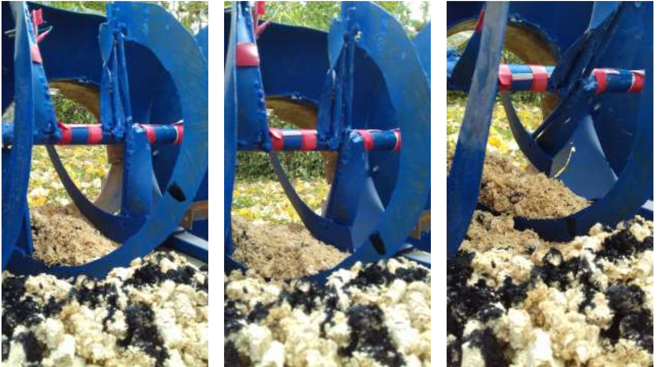
Рисунок 5.5 – Экспериментальная установка по определению фактически потерянной снежной массы при различных углах поворота фрезы
