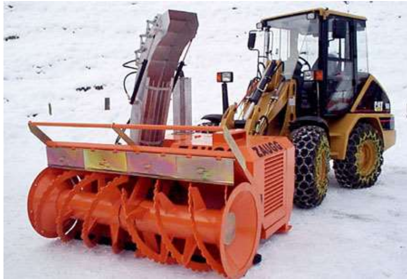
Рисунок 1.20 – Моноблок МВ-73 ZAUGG с фрезерно-роторным рабочим органом ZAUGG SF-72
