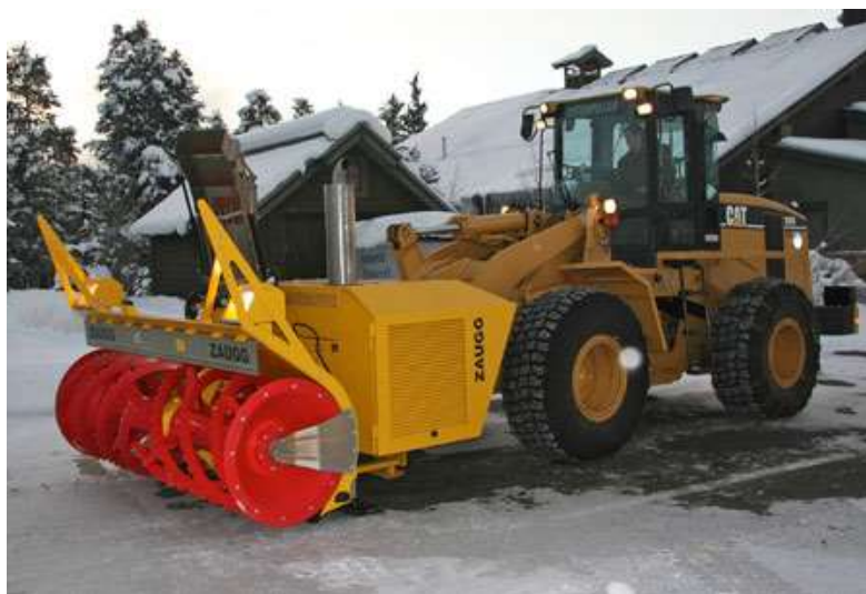
Рисунок 1.19 – Моноблок Mobi 170 ZAUGG с фрезерно-роторным рабочим органом ZAUGG SF-90-85-R
