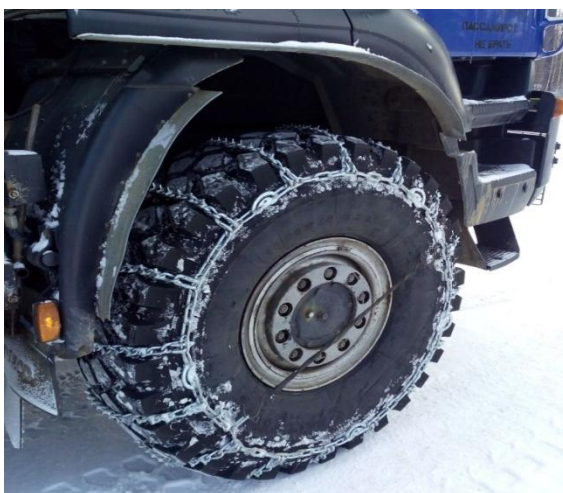
Рисунок 1 – Внешний вид колеса грузового автомобиля с цепью против скольжения для движения на участках дорог с подъемами и спусками в суровых условиях Крайнего Севера (Республика Саха (Якутия)) (фото сделано самостоятельно С.А. Вахрушевым)
