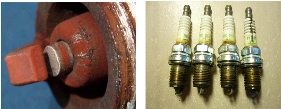
Рисунок 3 – Примеры неисправных свечей зажигания
