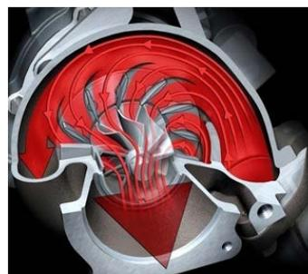
Рисунок 2 – Движение отработавших газов в каналах турбины радиально-осевой
