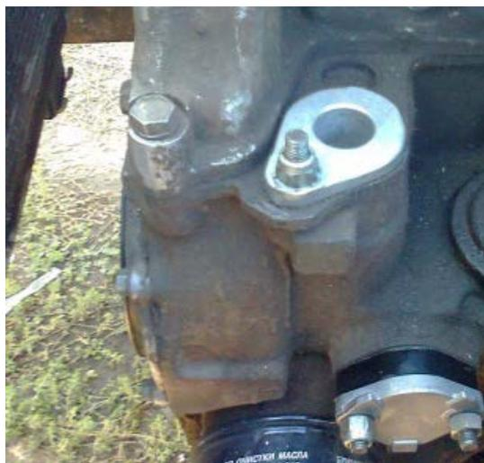
Рисунок 5 – Расположение заглушек трамблера и бензонасоса
