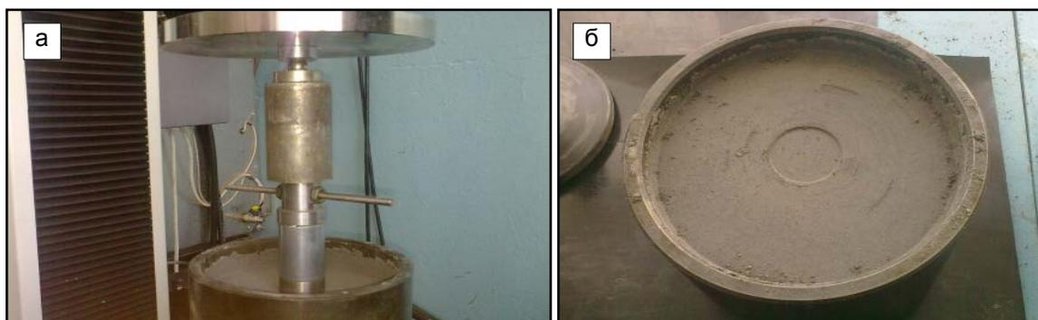
Рисунок 2 – Определение модуля упругости ЗШС:
