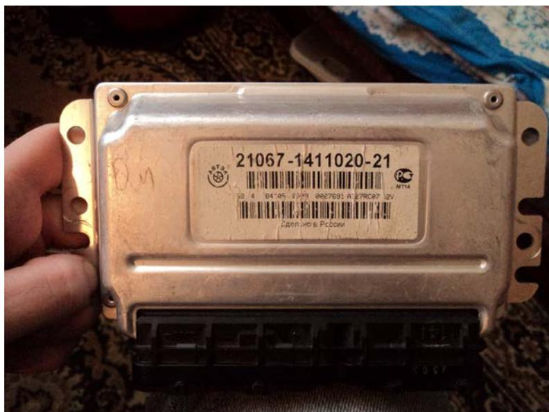
Рисунок 4 – Электронный блок управления двигателем М73
