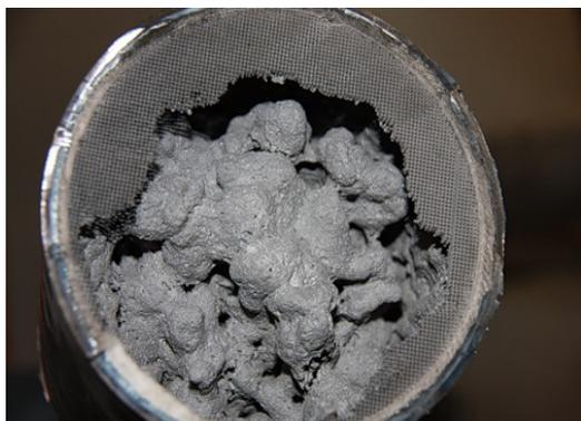
Рисунок 4 – Пример оплавления основы нейтрализатора
