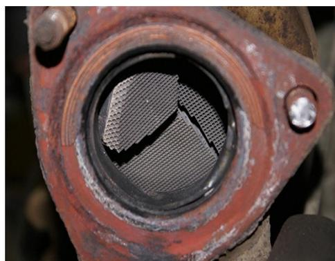
Рисунок 5 – Пример разрушения керамической основы нейтрализатора (растрескивание)
