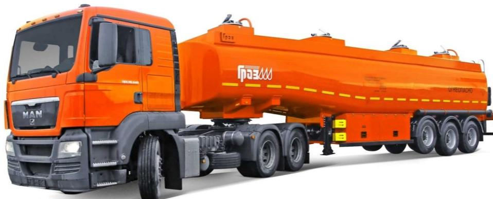
Рис. 1. Полуприцеп-цистерна из конструктивной стали
