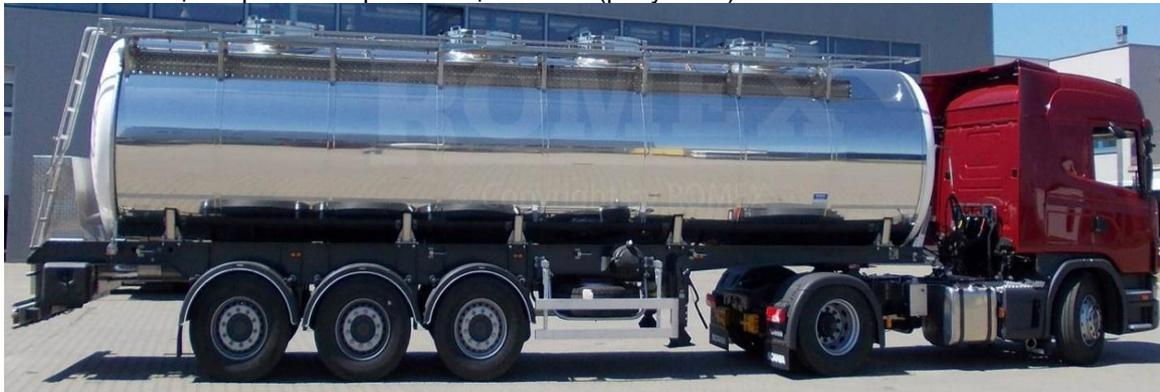
Рис. 3. Полуприцеп-цистерна из нержавеющей стали
