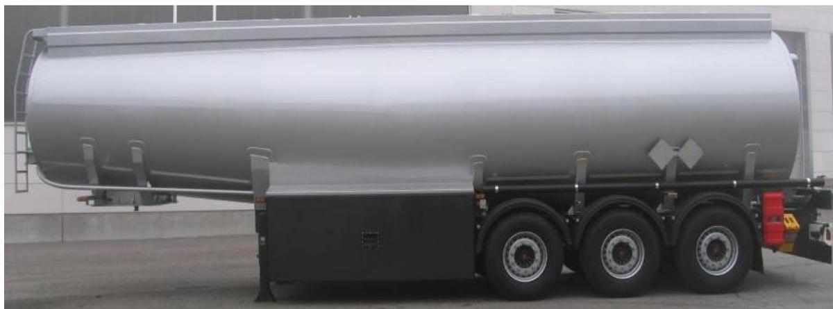
Рис. 2. Полуприцеп-цистерна из алюминия
