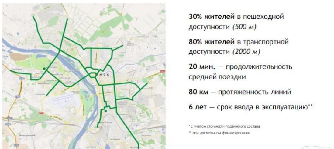
Рис. 3. Схема предлагаемой системы ЛРТ
