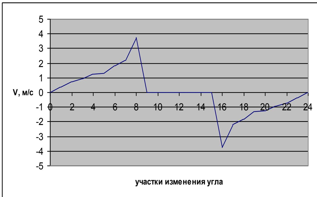
Рис. 4. График скорости толкателя
