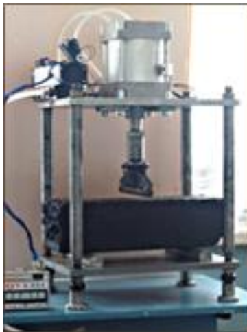
Установка для программируемого циклического нагружения образцов (размещается в климатической камере)
