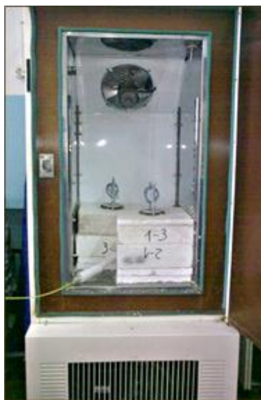
Установка для испытаний грунтов на морозное пучение
