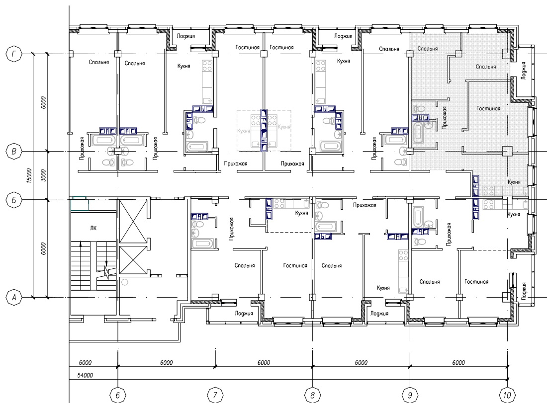
Р и с у н о к С.11 – Схематичный план секции многоэтажного жилого дома
