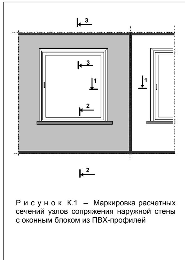
Р и с у н о к К.1 – Маркировка расчетных сечений узлов сопряжения наружной стены с оконным блоком из ПВХ-профилей
