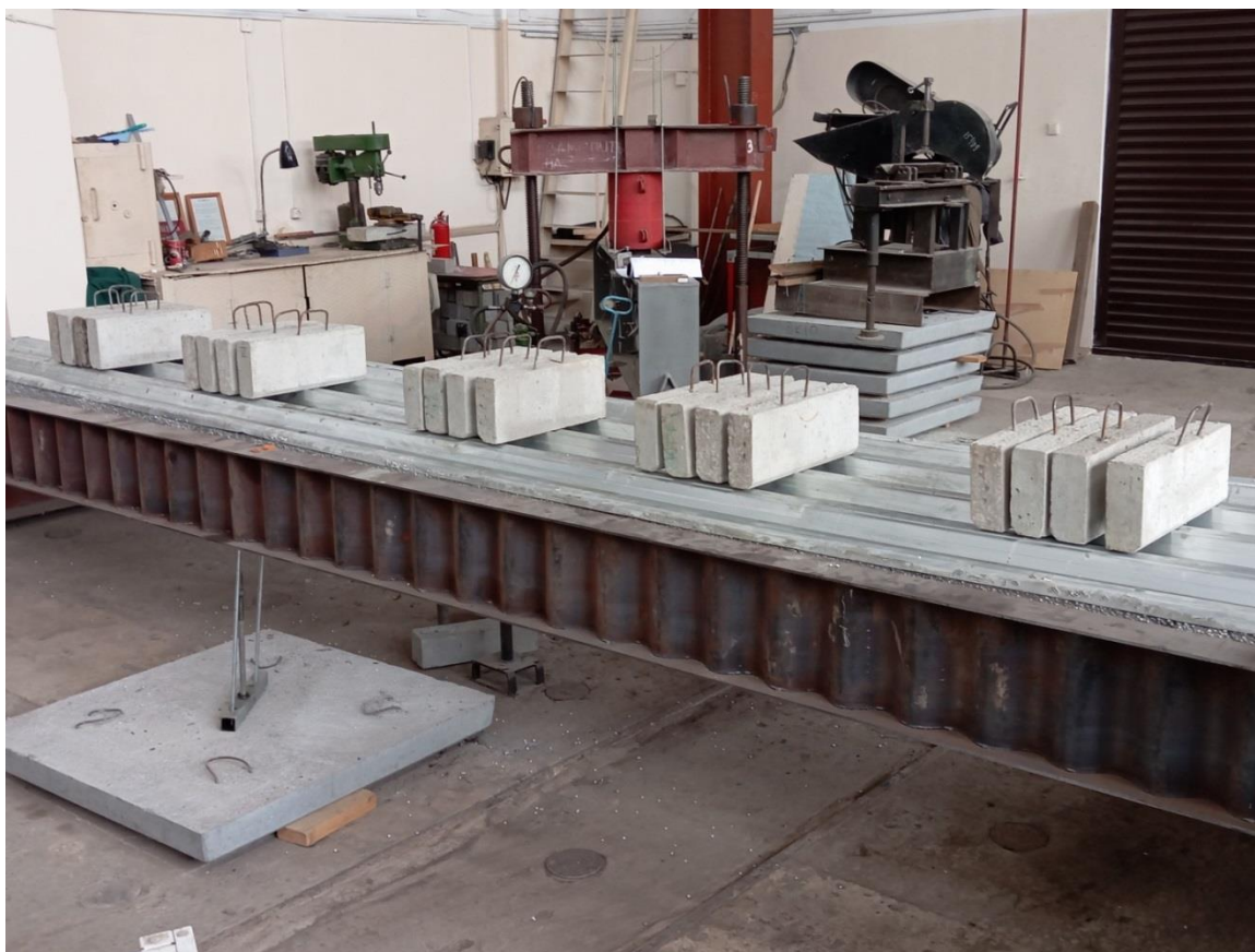
Рис. 5.8 Опытный образец под нагрузкой
