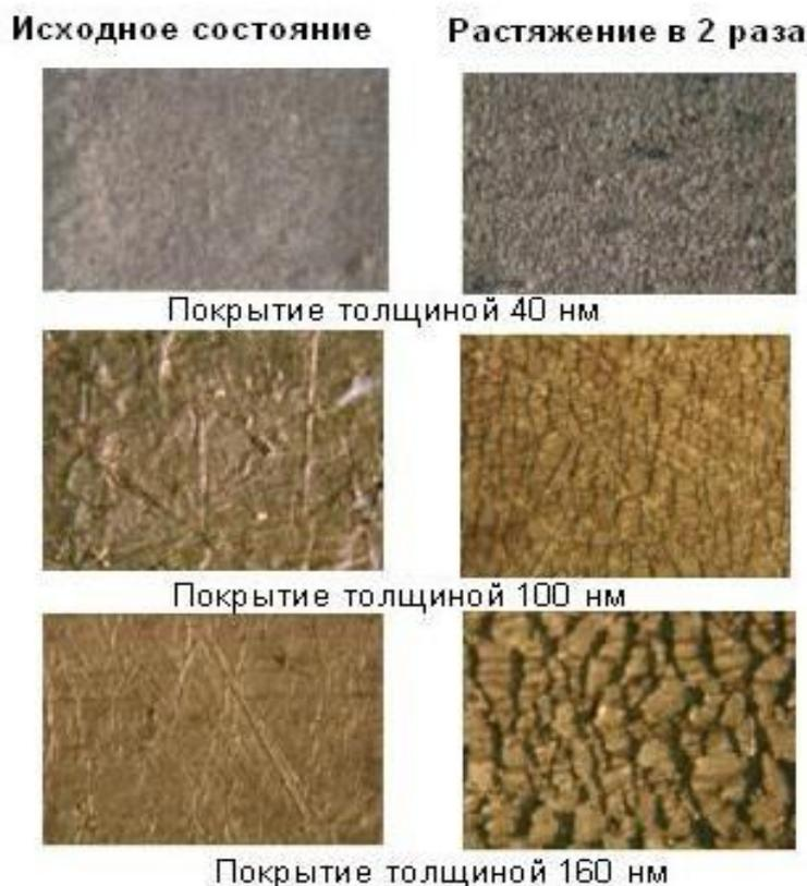
Рис. 1. Морфология НСТП, нанесенного на поверхность износобензостойкой резины 1287НТА
