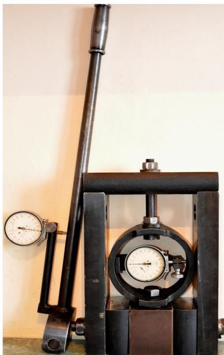
Рис. 1. Устройство для нагружения резьбовых пар «шпилька-гайка» и динамометрический ключ
