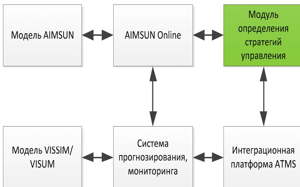
Рис. 5. Упрощенная структурная схема комплекса поддержки принятия решений по управлению транспортными потоками
