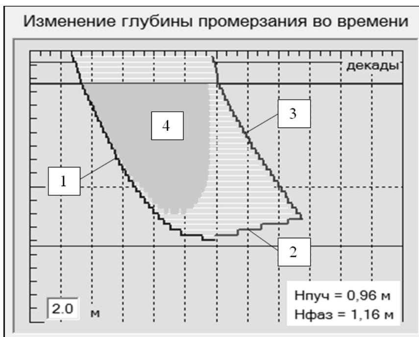
Рис. 5. Изменение глубины промерзания земляного полотна из ЗШС во времени (дата начала – 1 октября 2010 г.): 1 – граница промерзания ЗШС ( $T_{ф} = -0,3^{\circ}\text{C}$ ); 2, 3 – граница оттаивания ЗШС ( $T = 0,0^{\circ}\text{C}$ ); 4 – зона интенсивного морозного пучения, ограниченная изотермой  $T = -2,0^{\circ}\text{C}$
