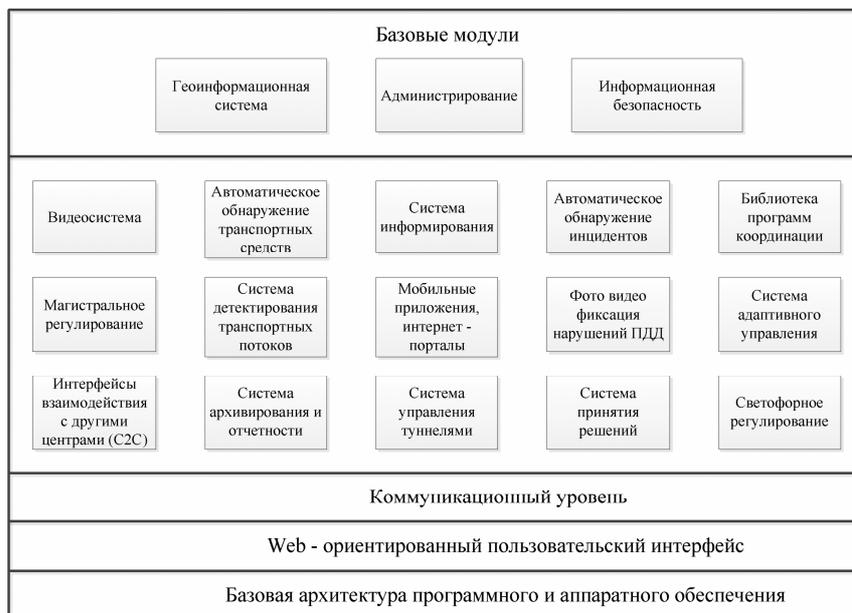
Рис. 2. Функциональная структурная схема интеграционной платформы ATMS
