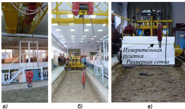
Рис. 1. Грузоподъемная кран-балка при проведении экспериментальных исследований
