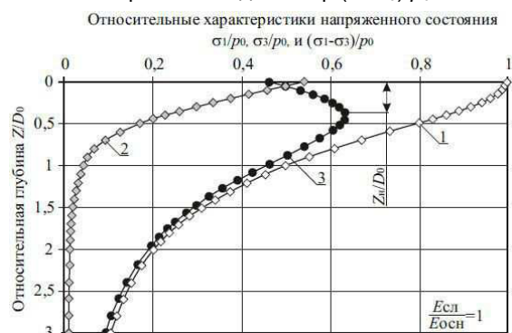
Рис. 3. Зависимость характеристик напряженного состояния от глубины, вычисленные по модифицированной модели М. И. Якунина при a=1 ; c=3 ; \mu=0,35 и E_{сл}/E_{осн}=1 1-3 – Максимальное \sigma_1/p_0 , минимальное \sigma_3/p_0 напряжение и девиатор (\sigma_1-\sigma_3)/p_0
