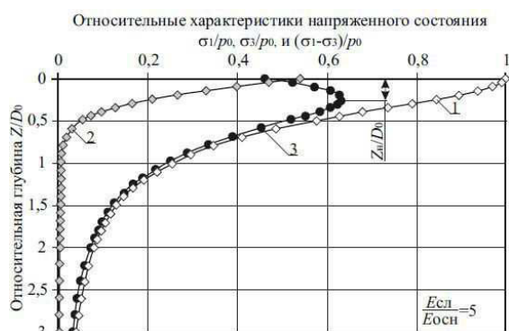
Рис. 2. Зависимость характеристик напряженного состояния от глубины, вычисленные по модифицированной модели М. И. Якунина при a=1 ; c=3 ; \mu=0,35 и E_{сл}/E_{осн}=5 1-3 – Максимальное \sigma_1/p_0 , минимальное \sigma_3/p_0 напряжение и девиатор (\sigma_1-\sigma_3)/p_0
