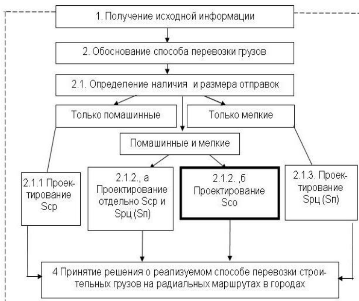
Рис. 1. Схема методики обоснования технологии перевозок грузов автомобильным транспортом в городах
