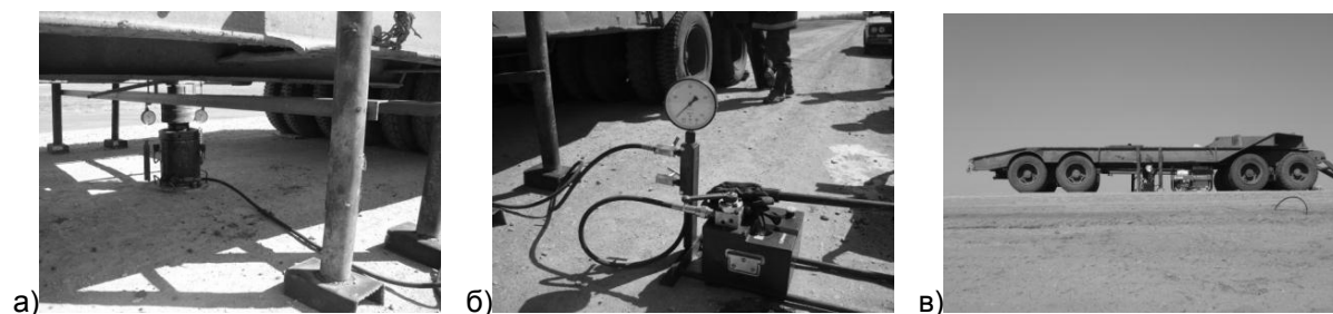
Рис. 1. Установка для проведения штамповых испытаний стабилизированных и нестабилизированных грунтов: а – штамп с домкратом; б – маслостанция с манометром; в – грузовая платформа
