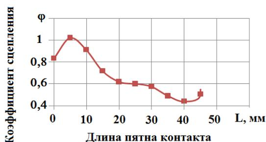
Рис. 4. Зависимость коэффициента сцепления колеса с эластичной шиной (марка AMTEL-175/65 R14) с цилиндрической опорной поверхностью бегового барабана по длине пятна контакта (диаметр бегового барабана 0,24 м, нормальная нагрузка  $R_z=3150$  Н, давление в шине  $P_w=0,21$  МПа)
