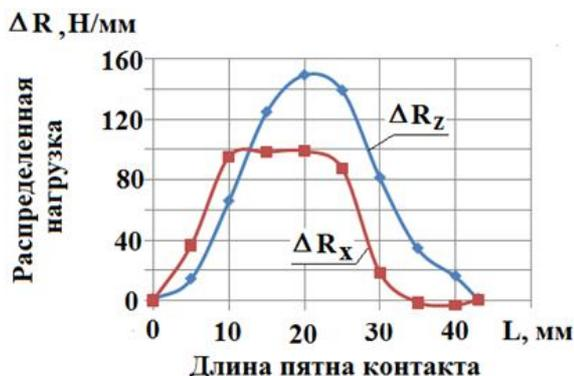
Рис. 3. Распределение нормальных и продольных касательных нагрузок по длине пятна контакта при качении эластичной шины (Yokohama Decibel 205/65R 15; давление в шине  $P_w = 0,21$  МПа; нормальная нагрузка  $R_z = 3150$  Н) по цилиндрической опорной поверхности (диаметр бегового барабана 0,24 м) в тормозном режиме (продольная тормозная сила  $R_x = 2145$  Н)
