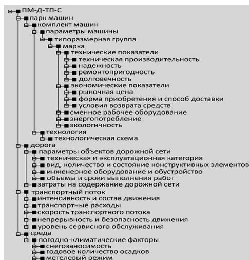
Рис.1. Структурная схема системы ПМ–Д–ТП–С
