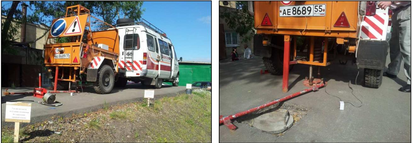
Рисунок 72 – Определение модуля упругости на поверхности покрытия при помощи УДН ДИНА-3М
