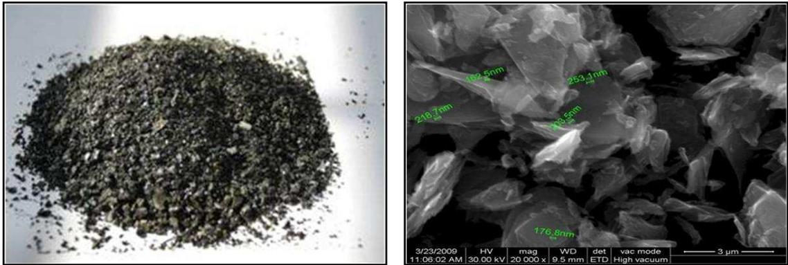
Рисунок 5 – Внешний вид гранулированного шлака (слева) и вид этого шлака под микроскопом (справа)
