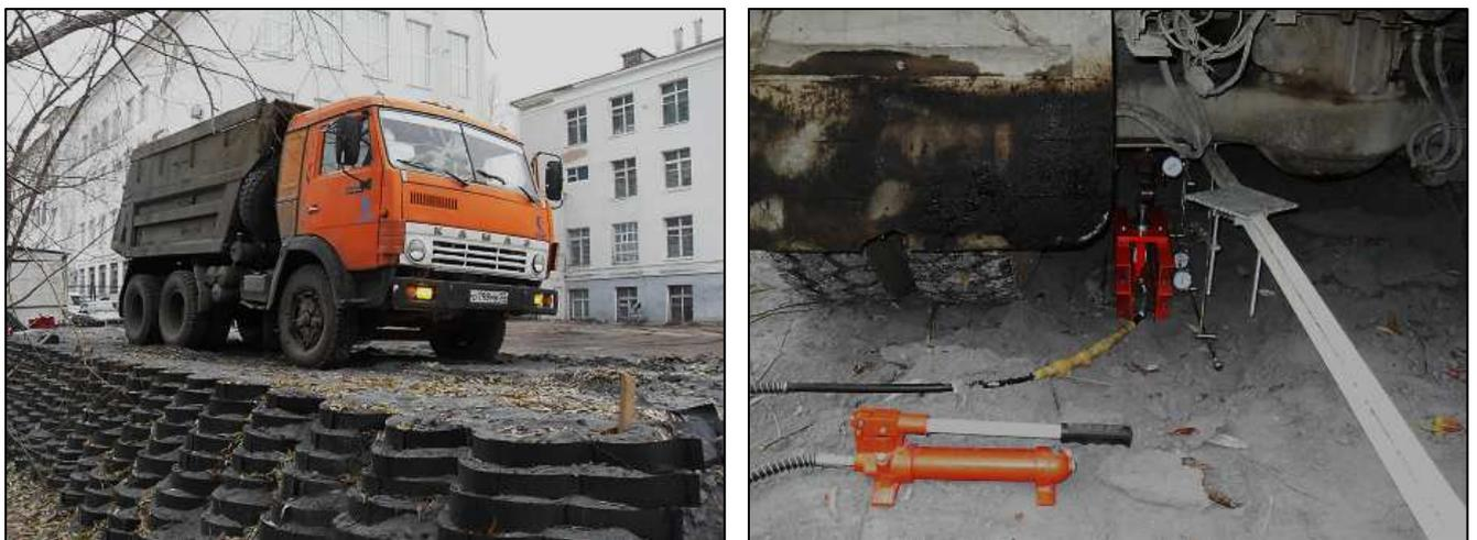
Рисунок 68 – Проведение штамповых испытаний на поверхности земляного полотна из ЗШС
