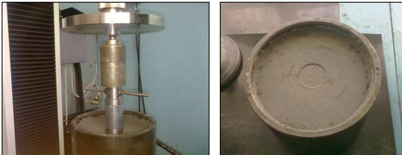
Рисунок 23 – Внешний вид испытательной формы заполненной ЗШС (слева) и отпечаток штампа на образце после испытаний (справа)
