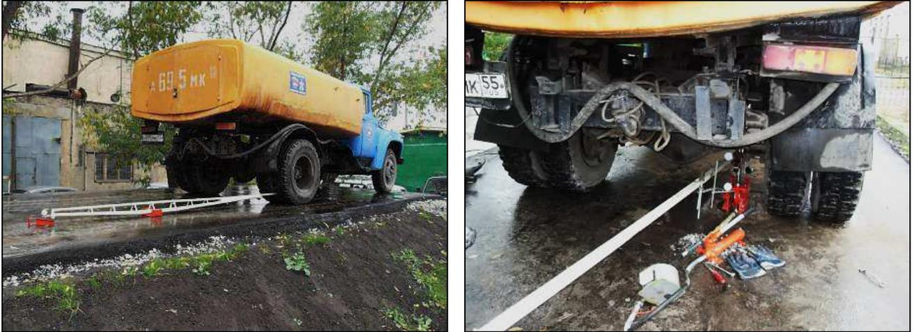
Рисунок 71 – Определение общего модуля упругости дорожной конструкции
