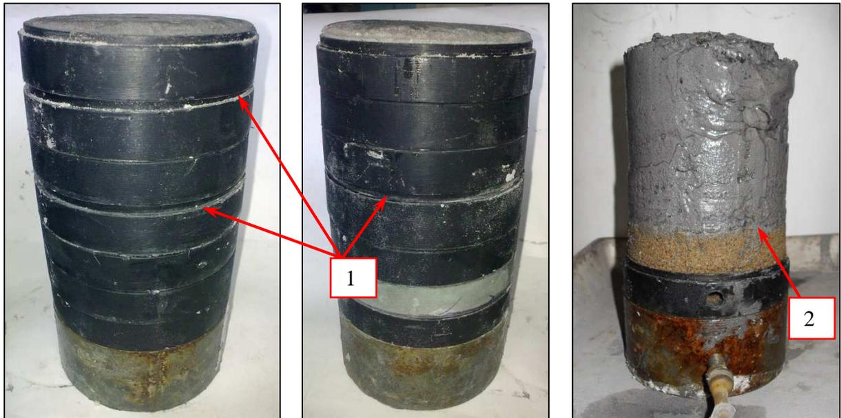
Рисунок 49 – Вид образцов после испытания: 1 – перемещение колец формы в ходе промерзания грунта; 2 – граница слоев песка и ЗШС
