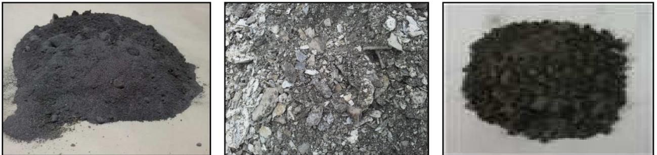
Рисунок 3 – Внешний вид золошлаковой смеси различного гранулометрического состава
