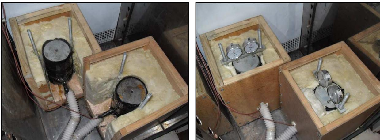
Рисунок 42 – Подготовка установок с грунтом для определения морозного пучения в климатической камере
