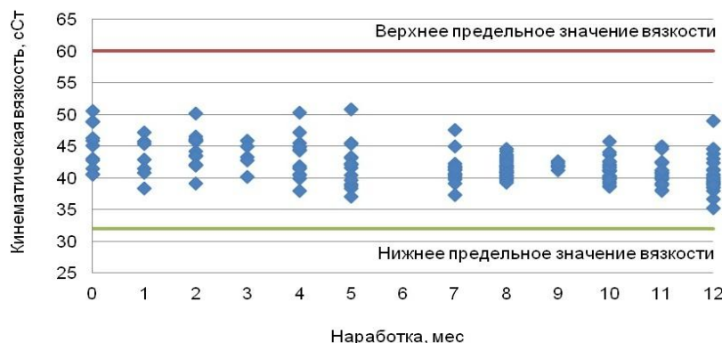
Рис. 2. Изменение вязкости смазочного материала за год эксплуатации ДРО
