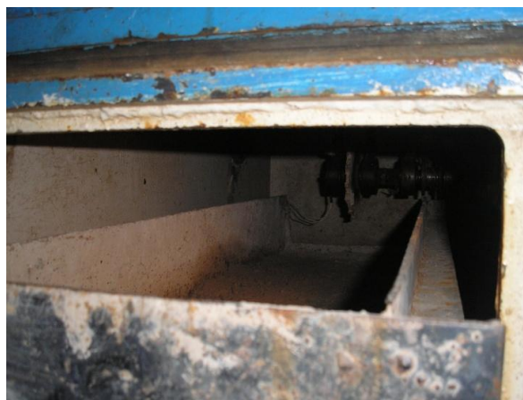
Рис. 4. Роторно-дисковый рабочий орган, установленный в герметичном корпусе
