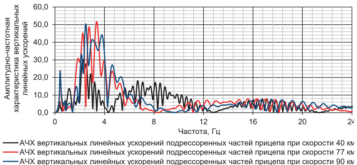
Рис. 3. Амплитудно-частотные характеристики вертикальных линейных ускорений подрессорных частей прицепа с тандемными осями
