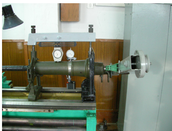
Рис. 4. Внешний вид установки для ускоренных испытаний узла балансира ходовой части МГМ
