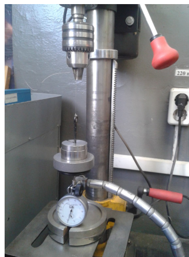
Рис. 3. Схема и общий вид установки для испытаний извлеченной проволоки на растяжение: 1 – зажим, 2 – испытываемая проволока, 3 – платформа для грузов, 4 – микрометр
