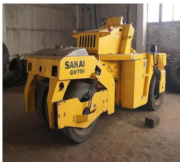
Рис. 6. Вибрационный пневмошинный каток Sakai GW-750 (Япония)
