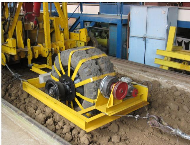
Рис. 2. Уплотнение суглинистого грунта адаптивным катком
