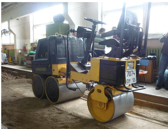
Рис. 3. Уплотнение суглинистого грунта вибрационным катком ДУ-107 (ЗАО Раскат)
