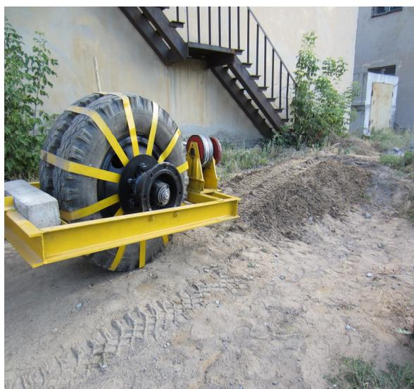
Рис. 4 . Уплотнение супесчаного грунта адаптивным катком
