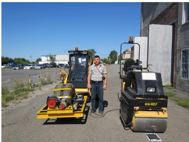
Рис. 1. Опытный образец адаптивного катка и вибрационный каток ДУ-107 (ЗАО Раскат)
